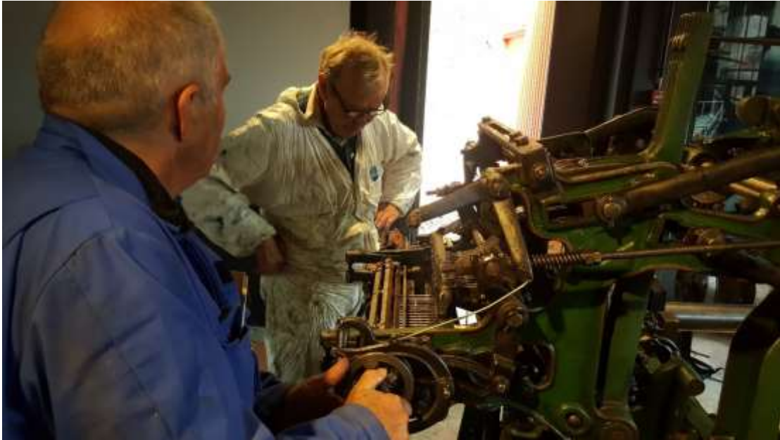
Her er hullkortstyringen for skaftene nærmest og for skytlene lengst bort, uten kortene påmontert.
