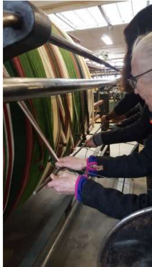
Oppstart av påknyting på stanga.
