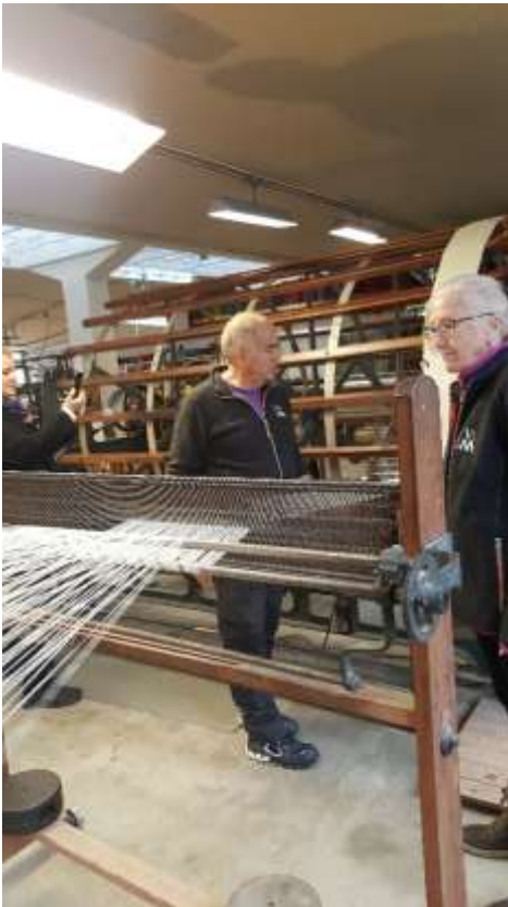
Første bånd blir lagt på rennebommen.
