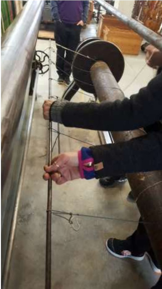
Justering av stanga som renninga skal knytes på for så å bli dratt jevnt over på renningsbommen.
