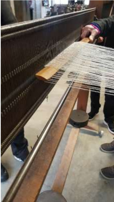
Sjekk av skillet før skillebåndet blir lagt inn.
