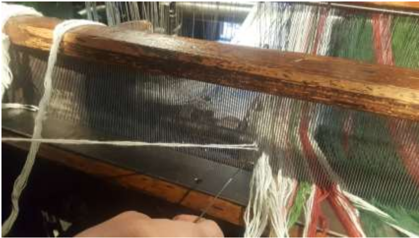
To og to tråder trekkes mellom to tinder i skjea.
