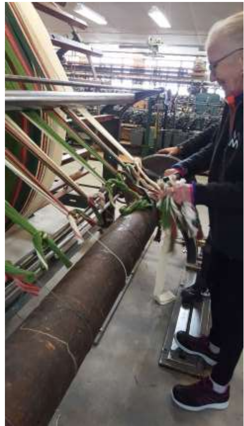
Knutene strammes jevnt. Endene klippes.
