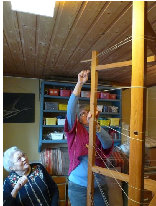
Renninga klargjøres på rennebommen. Her er det Ingrid som renner under kyndig veiledning av Synnøve.
