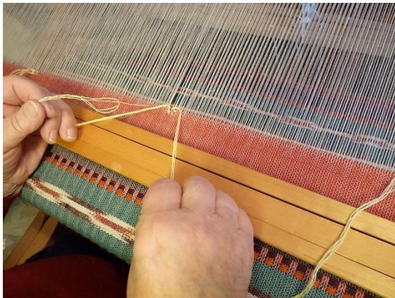
Den første innsmettingen skjer ved at en firedobbel tråd smettes under seks renningstråder. Her ble det begynt på midten av tråden og mellom hver smetting er det to innslag med bunnfargen.
