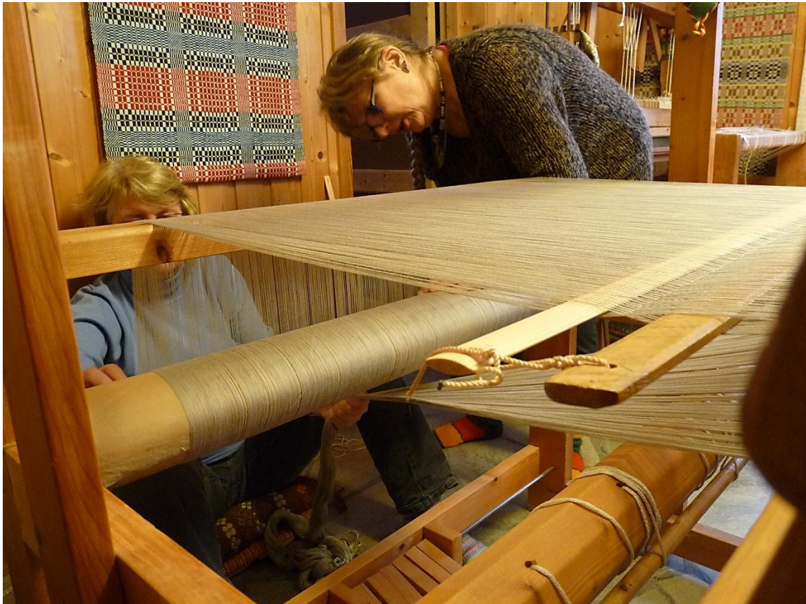
Veven blir sveipet og her ser en skillepinnene som nå er flyttet bak skeia. Ingrid sitter på gulvet bak veven og holder renninga fast og jevn når den blir sveipet på. Anne Perny passe på at spiler og papir kommer inn på riktig plass, samtidig som hun dreier hjulet for å få garnet på.
