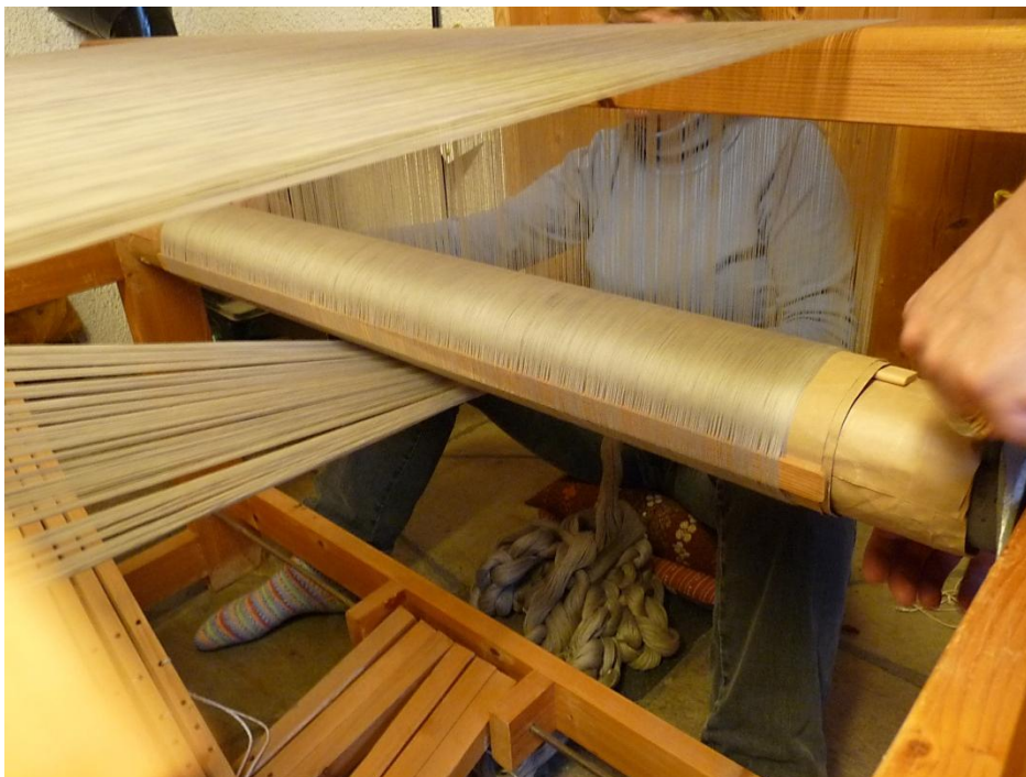
Her sitter Ingrid og holder i renningsgarnet. Dette må holdes fast og ikke la det bare skli igjennom hendene. Garnet går igjennom sveipeskeia der det blir «spredd» før det blir sveipt på garnbommen. Det legges på spiler og papir underveis i sveipinga. Papiret som ble brukt hos Synnøve var fra gamle melposer. Disse er ikke å få lenger i følge Synnøve
