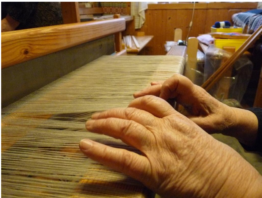
På andre siden av veven og vevskeien sitter Synnøve og fordeler eller grupperer trådene, så de ikke skal «flope» seg
