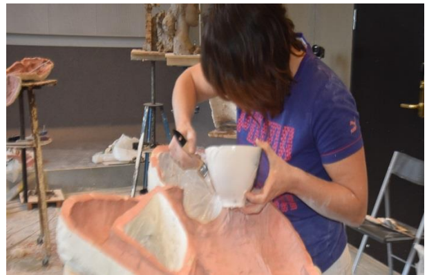
Et passende tykt lag gips (et par centimeter) påføres formdelene.
