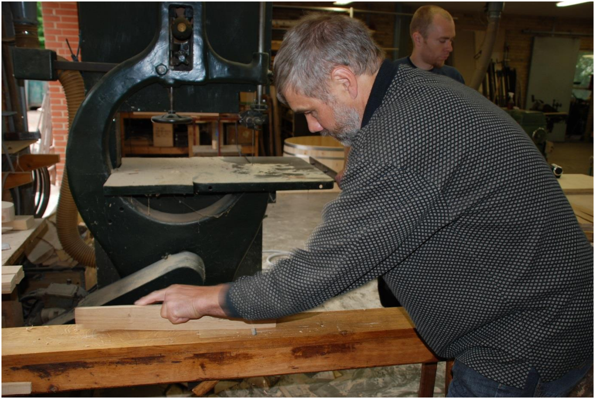
Gangstø stryker stav på strykebenken (stor høvel).
