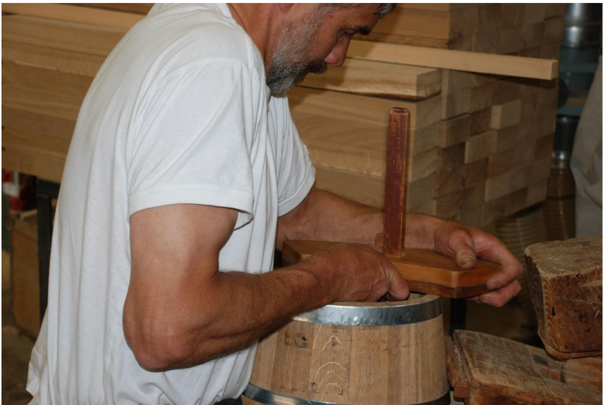
Gangstø bruker kryssjernet for å lage fals til bunn.
