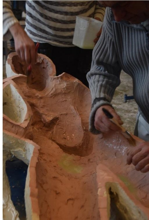
Slippmiddel av vann og såpe pensles innvendig i formen.
