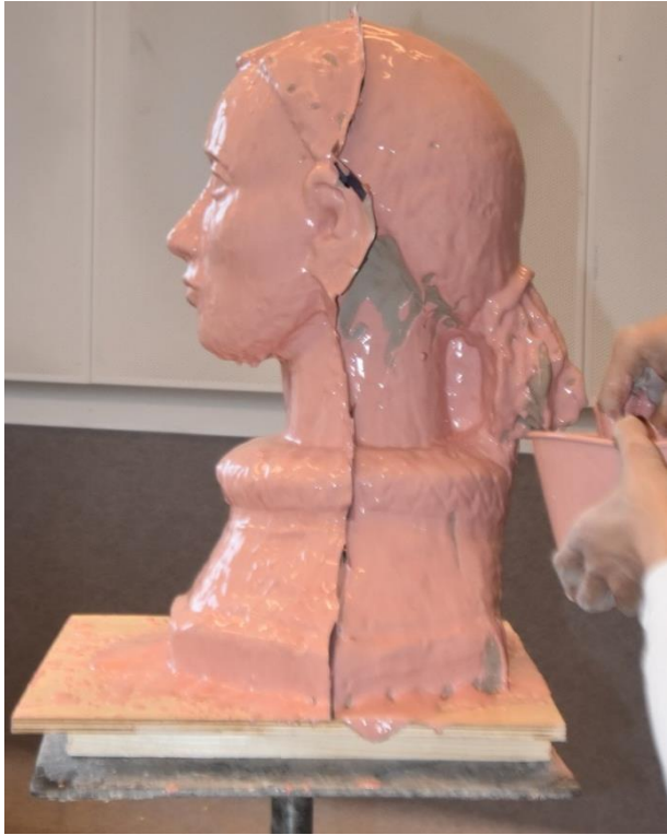
Hodeformen lages i bare to deler. Deleblikk er satt inn på de høyeste delene og rundt ørene.
