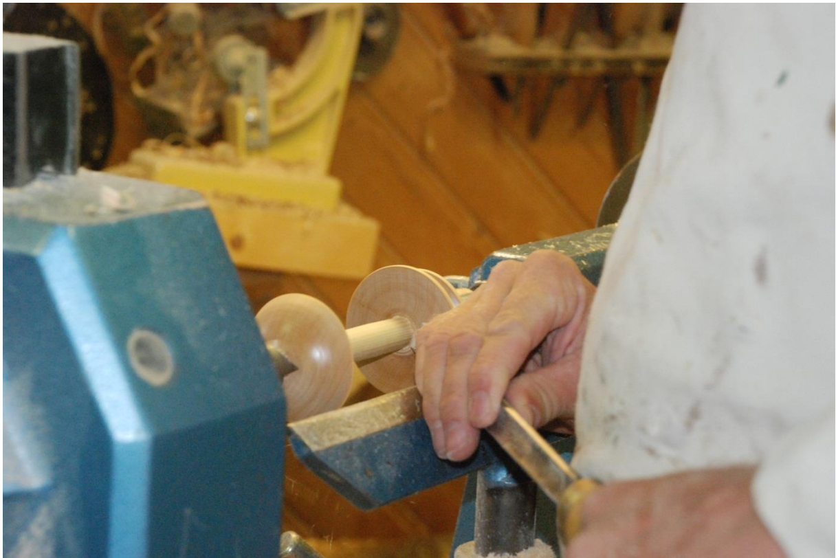
Eliassen dreier snelle. Denne er limt sammen av tre deler for å spare materialer.
