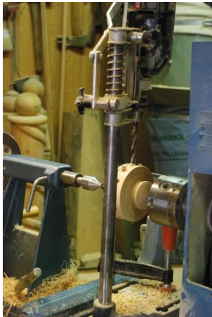
Det bores hull i navet til spiler.
