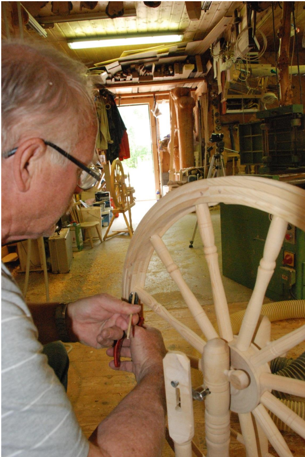
Bleken sikrer eikene med tynne treplugger. Eikene er satt inn til en fals eller kant i felgen og hindres i å komme ut av posisjon ved at det bores et lite hull i eiken og inn i felgen som deretter plugges.
