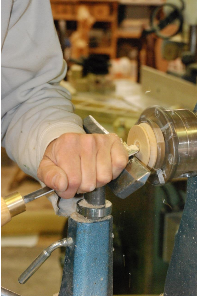
Trinsen dreies. Den ene delen av snora skal gå i spor på trinsen.
