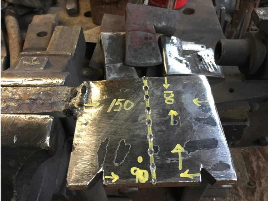
Starten på ei øks med fal, dvs. et kremmerhus der skaftet går inn. Mål oppgitt i mm. Metode, min egen, tufta på en svensk øksefilm fra Wira Bruk 1923, der vi ser en prosessmiing av ei faløks. Fantastisk film, må sees, se Youtube!
