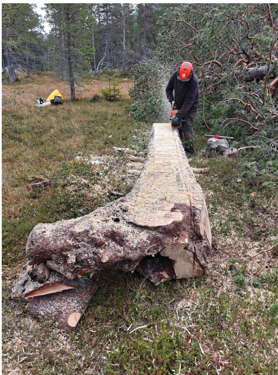
Bilde 66 Grovdimensjonering av vindskiemnet.
