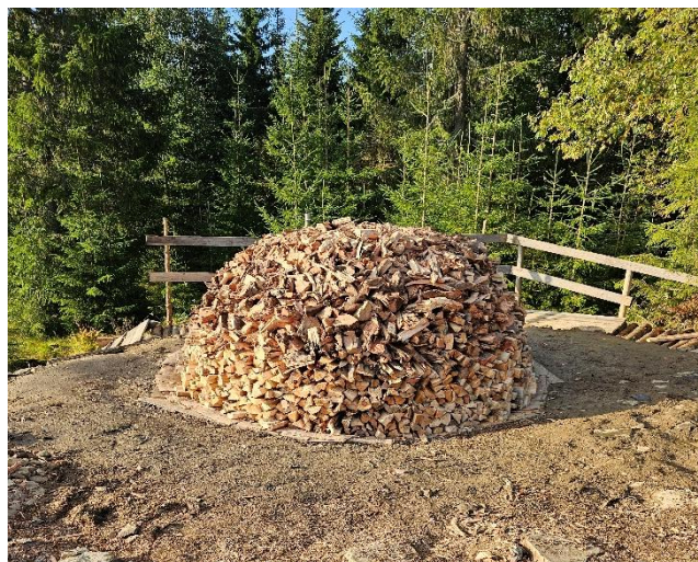
Bilde 92 Mila er bygd, og klar til å dekkes til. Torv med mye tyttebærlyng er passe tett.
