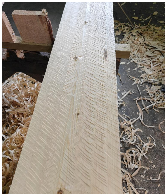
Bilde 37 Eksempel på spretteljing med 45 vinkel.
