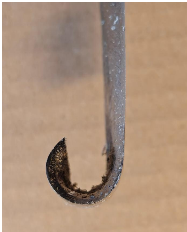
Bilde 12 Utformingen av eggen på grøypjernet. Den søker litt tilbake mot tangen, og kan dermed "grave" litt i kanten på tilesporet.
