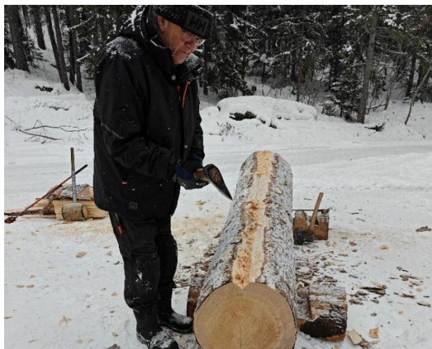
Bilde 29 Hans er i gang med å hogge V-sporet som vi hogger gjennom yteveden før kløyving.
