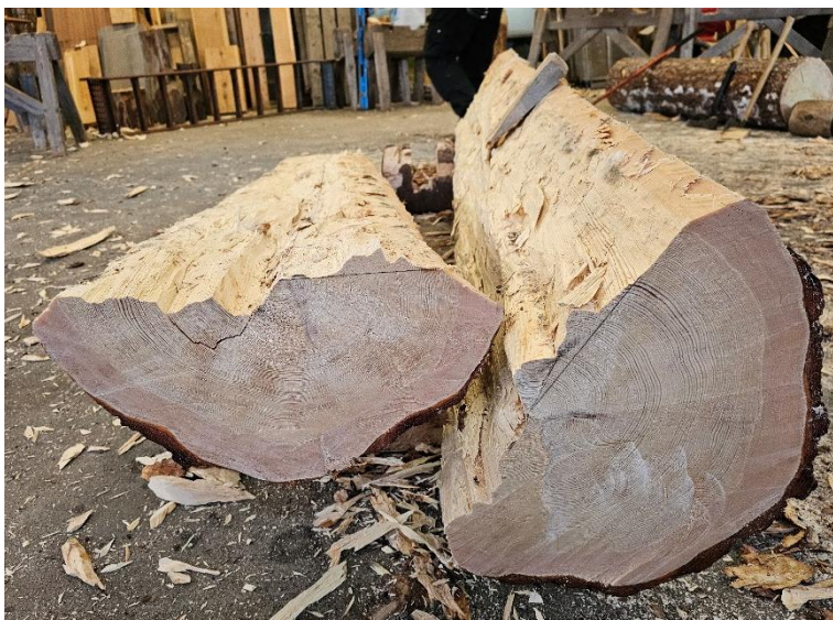
Bilde 31 Eksempel på en utrivning fra kløyvinga som ødelegger mye av emnet til venstre.
