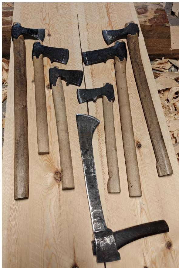
Bilde 6 Øksene jeg har brukt i takrytterprosjektet.
