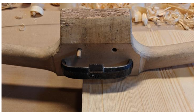
Bilde 8 Profilskavl med symmetrisk 19 mm profil. Her kan man flytte styrepinnen fra side til side under bruk.
