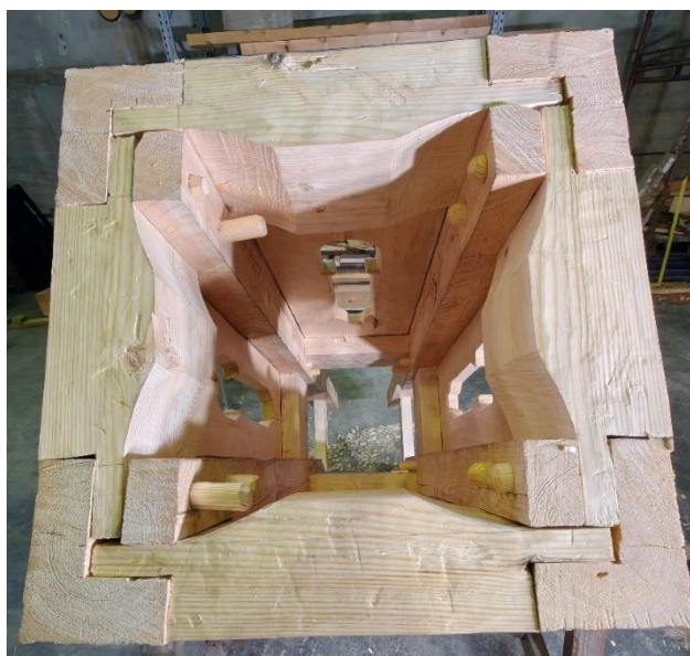
Bilde 80 Toppsvillene i øverste høyde har en litt annerledes utforming. På baksiden er det en mellomting mellom en kinning og en bue inn mot tappen.
