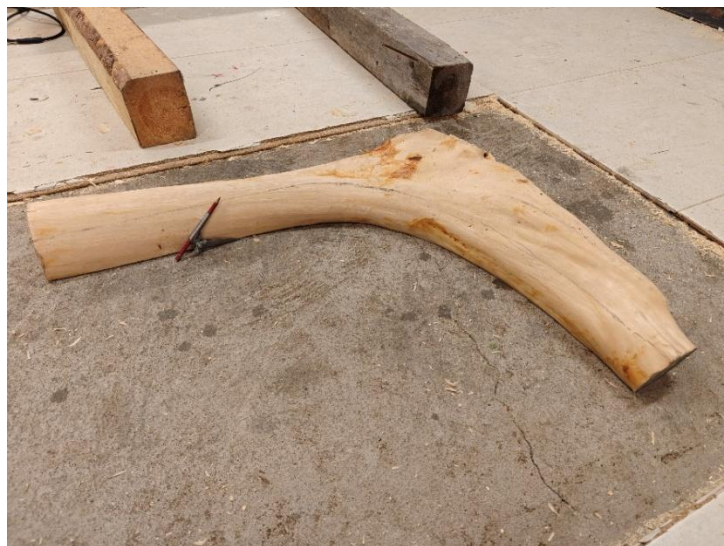
Bilde 70 Oppmerking av rotkne. Å legge ned kneet og merke etter noe tilnærmet flatt var en rasjonell måte å jobbe på.
