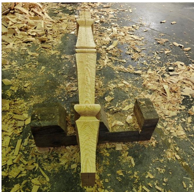
Bilde 86 Ferdig hogd til firkant.
