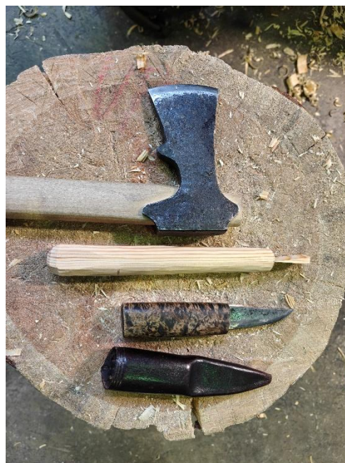
Bilde 41 Plugg med kontrakile klar til å slås inn.
