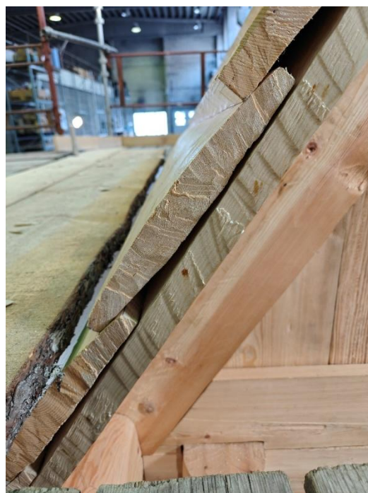
Bilde 59 Formen på de ferdig lagte trobordene.
