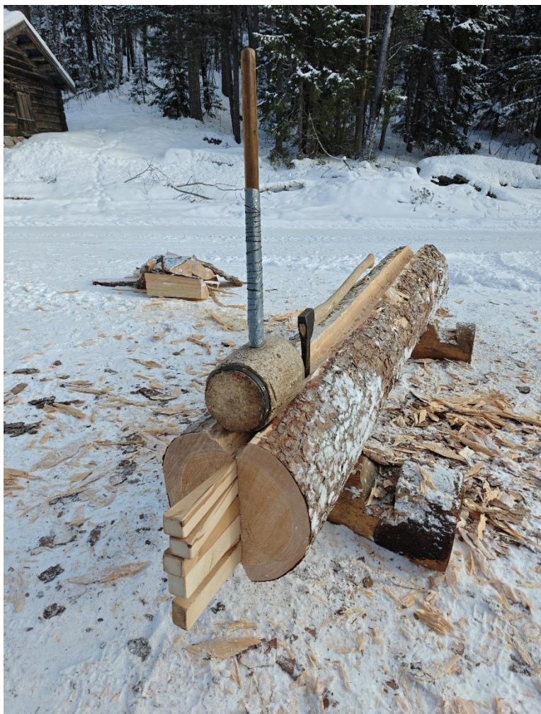
Bilde 30 I gang med å kløyve en stokk. Vi setter kiler i hele bredden av stokken, og bruker kløyveøkse til å lage rom for flere kiler på ryggen av stokken.
