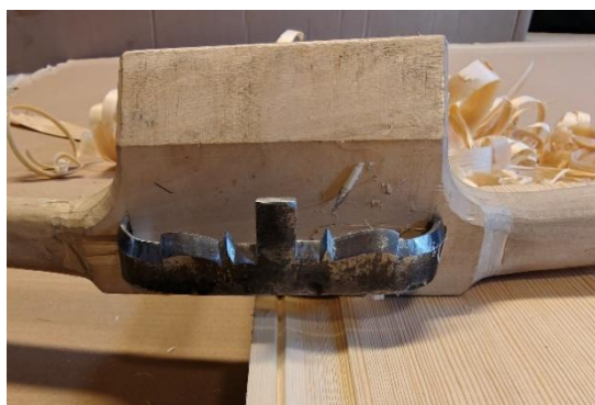
Bilde 9 Profilskavl med usymmetrisk profil. Noen av gjenbruksdelene i Borgund har denne profilen.
