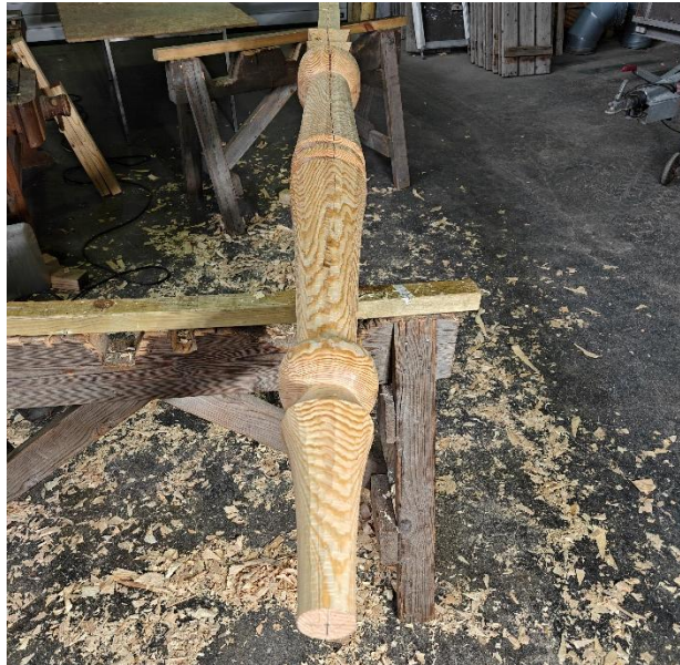
Bilde 89 Hogd til trettito kant. Klar til å høvles med skavl.
