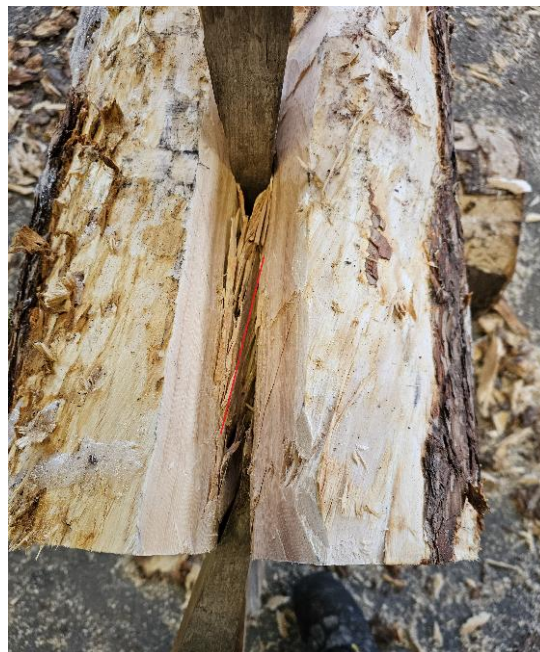
Bilde 2 Utrivning underveis i kløyvingen. Veden som går fra den ene kløyvingen og over i den andre, markert med rød strek.
