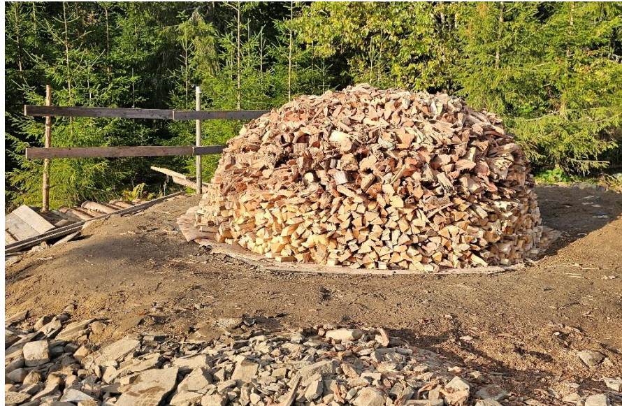
Mila ferdig stablet og klar for tetting med torv. Foto: Åsmund Stormoen.
