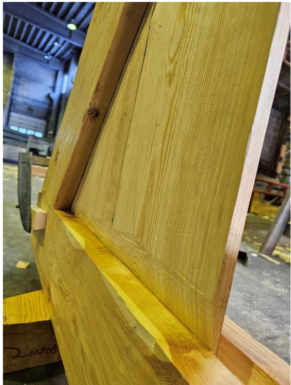
Fasing av veggtilene. Foto: Åsmund Stormoen.
