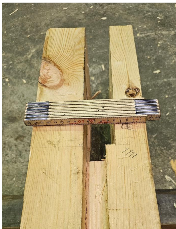
Bilde av tilespor og tapp. Venstre side er sammenfallende, mens tappen er breiere enn tilesporet. Foto: Åsmund Stormoen.
