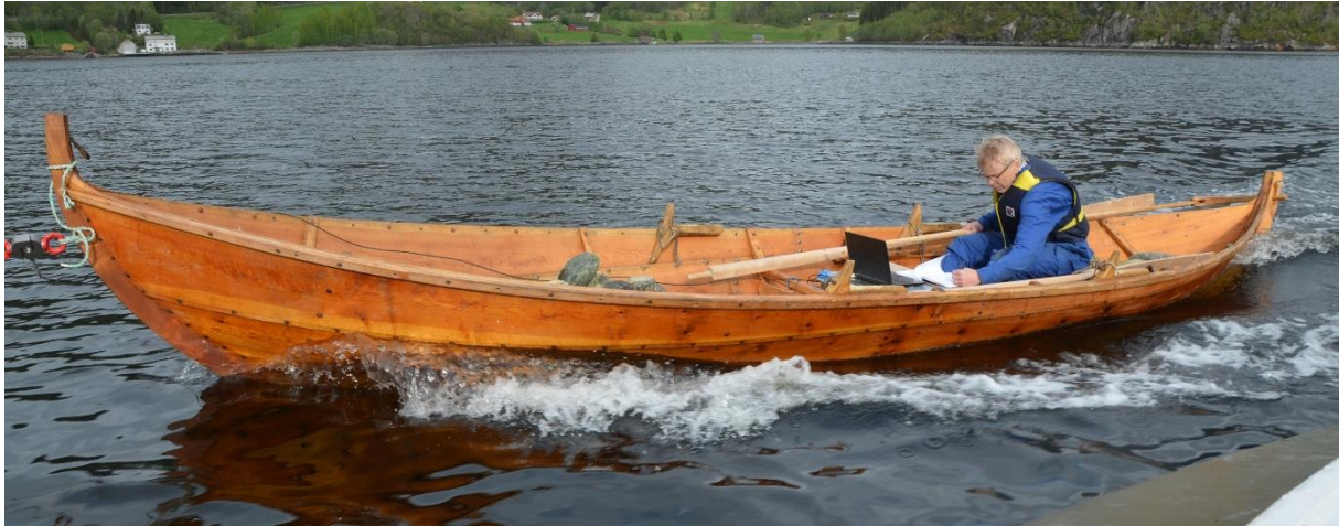
Figur 11. Teisten i 6 knop med 800 kg deplasement
