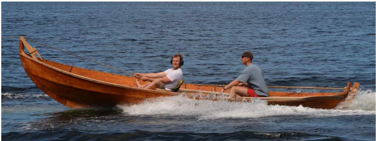
Figur 16. Teisten i 12 knop med ca. 400 kg deplasement
