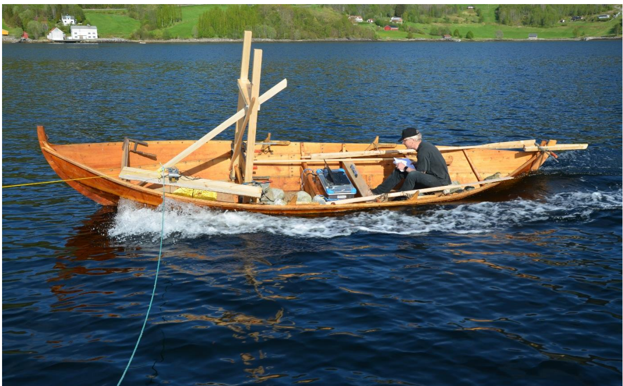
Figur 27. Teisten i 6 knop med 15 grader krenkning
