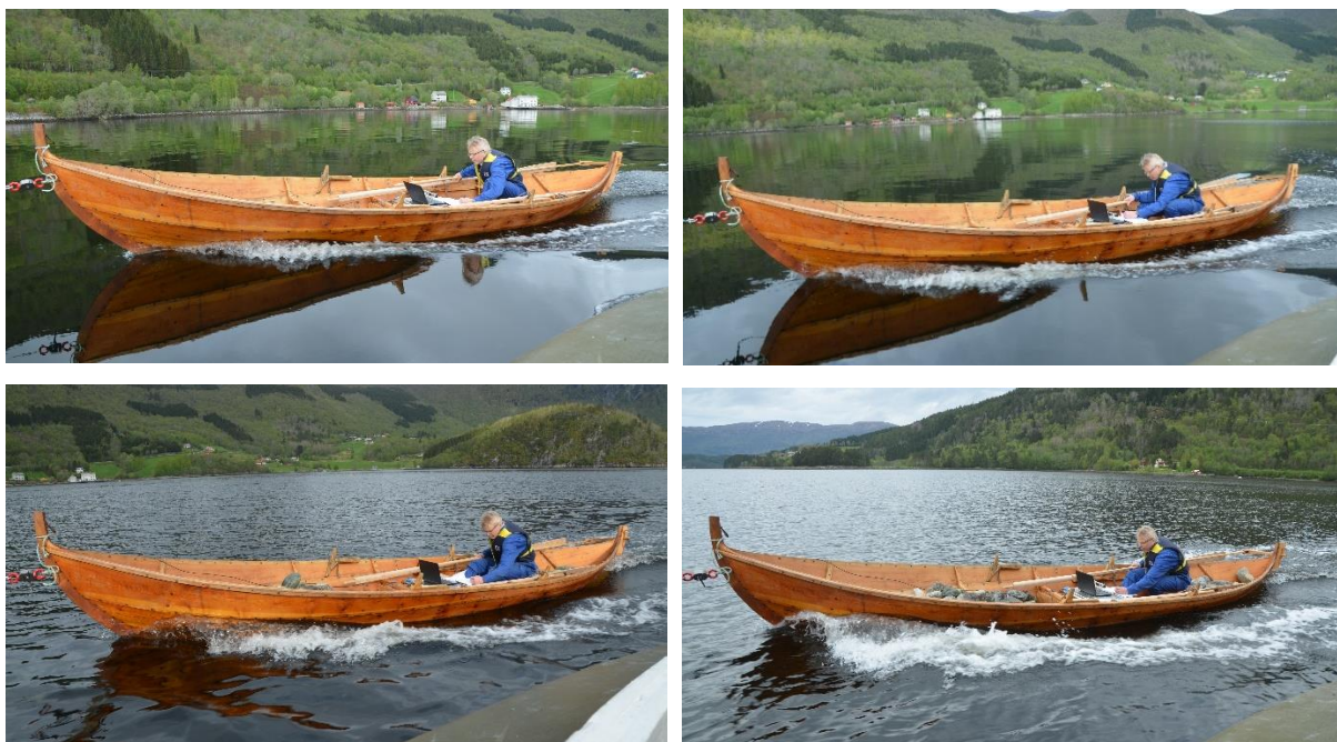
Figur 20. Teisten slepes i seks knop med ulike mengder last. Bildene er tatt ved hvert av punktene i den oransje grafen i fig. 19
