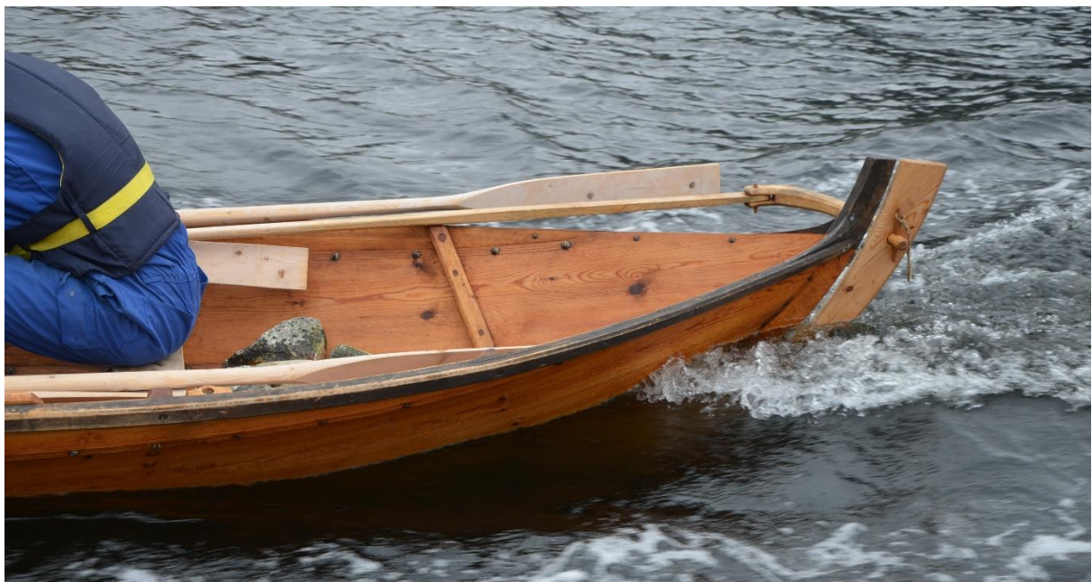
Figur 8. Teisto i 6 knop med 600 kg deplasement
