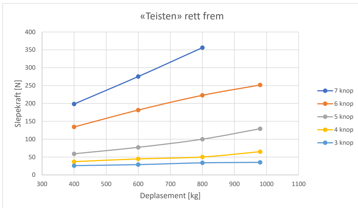
Figur 19. Vi ser at det er lettere å slepe Teisten med 980 kg deplasement i 5 knop enn med 400 kg deplasement i 6 knop. Grafen er litt misvisende fordi målingene ikke er gjort i nøyaktig de hastighetene som er oppført. Ved å studere fig. 18 kan en få et tydeligere bilde på de faktiske hastighetene da motstanden ble målt. Vi ser blant annet at med 800 kg deplasement ble båten slept i 6.75 knop, i stedet for 7 knop. Dersom hastigheten faktisk var 7 knop, hadde motstanden blitt nærmere 400 (N) i stedet for 356 (N).
