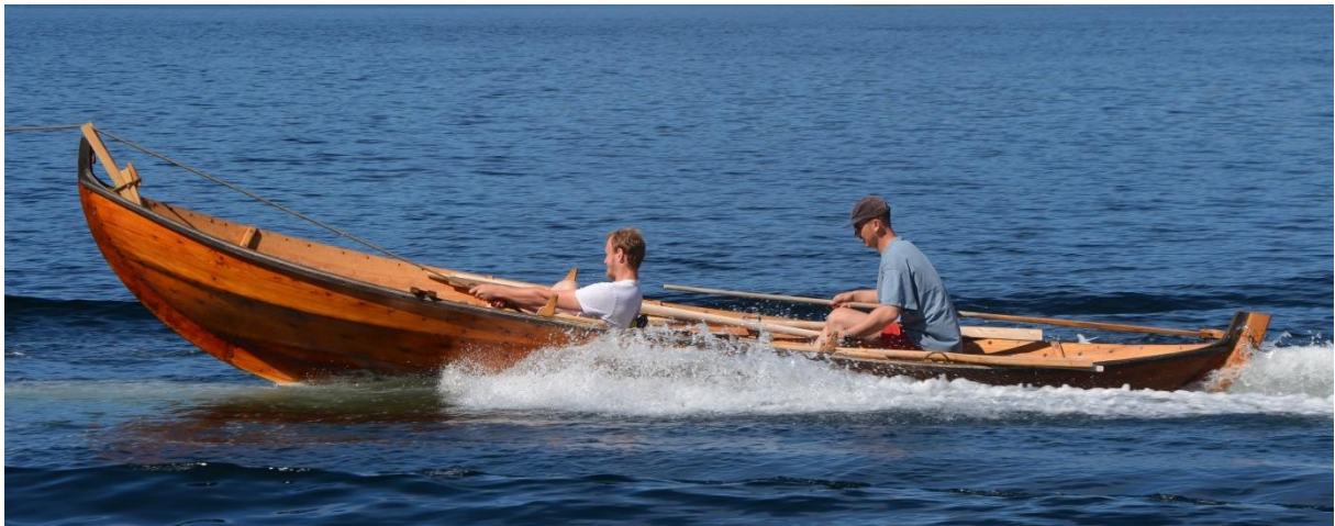
Figur 17. Testo i 12 knop med ca. 400 kg deplasement
