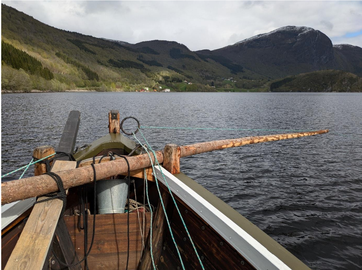
Figur 4. Det ble montert en bom på skrå ut foran slepebåten, som færingene ble slept etter.
