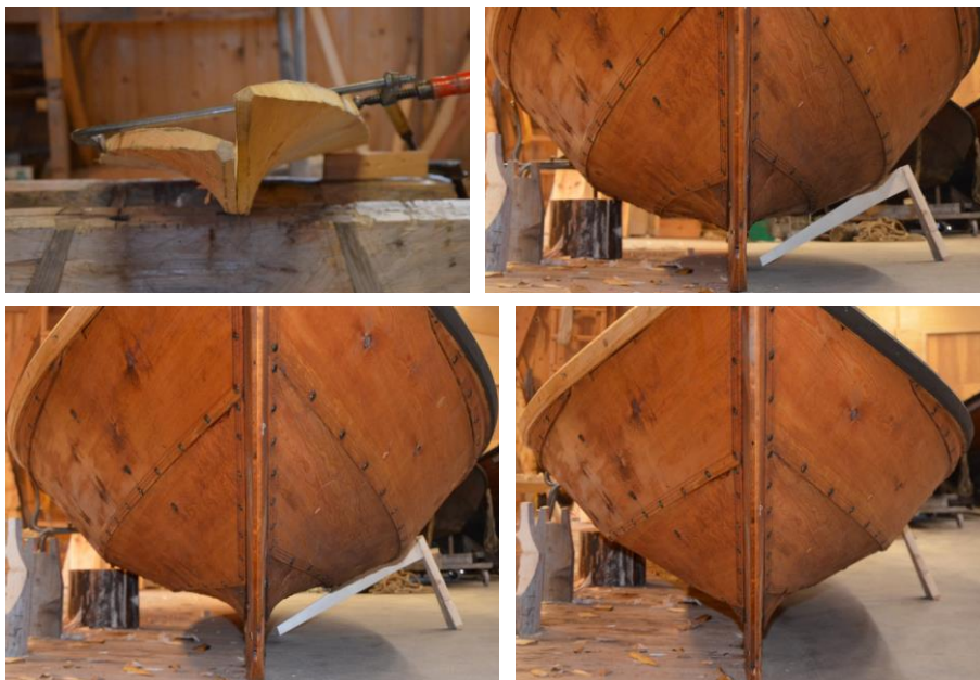
Figur 5-7 Sammenlikning av halsemner til Teisten og Testo og de ferdige båtene. T.v. på hvert bilde er Teisten, og t.h. er Testo.
