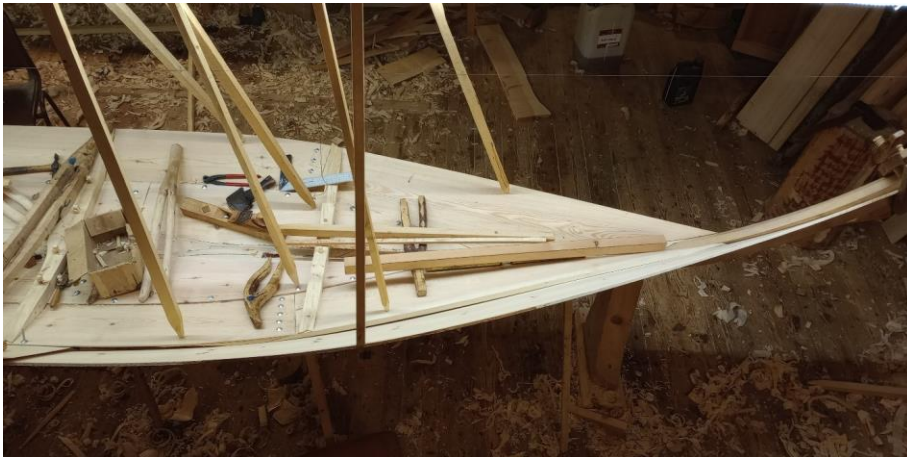
Figur 8 Malbord som ble bøyd på Teisten for å kunne planlegge kjempa til Stemshesten. Bildet viser godt hvordan den ble.
