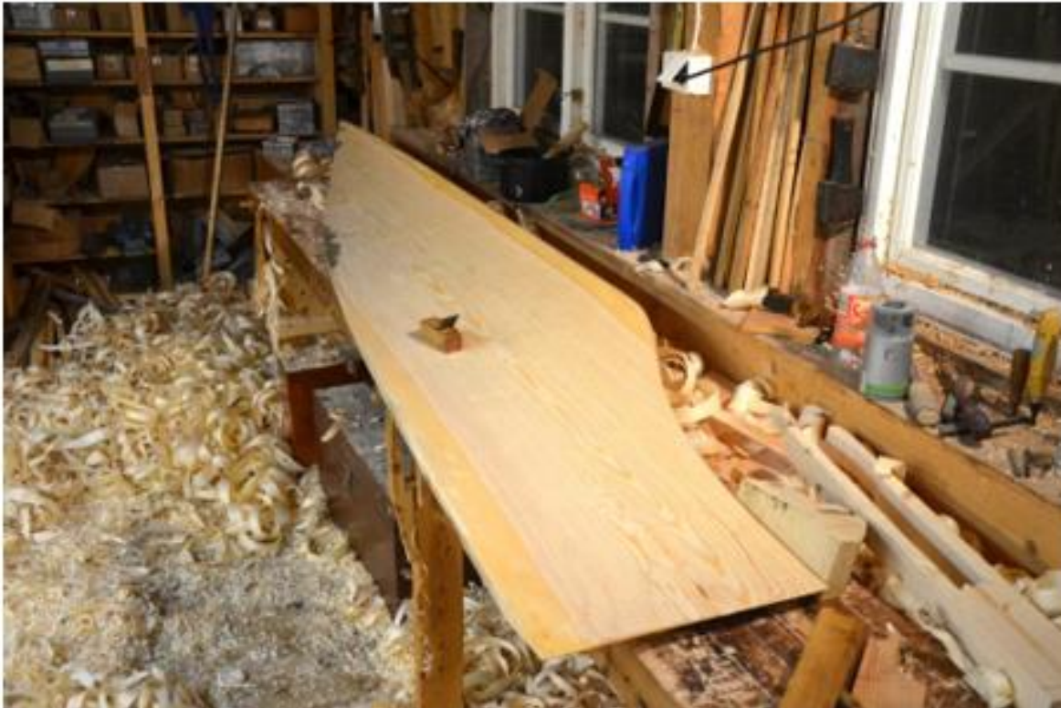
Siste finish på framhalsen . Helt alminnelig pusshøvel for skalering.
