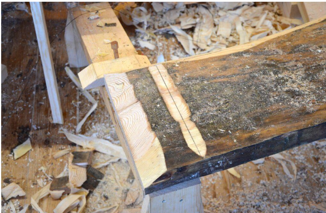
Skaringa til framhalsen er i ferd med å bli felt.
