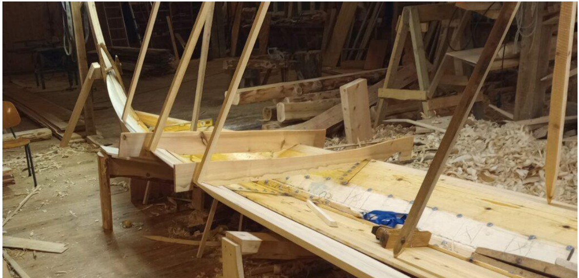
To bukker og tre skorder måtte til utvendig for å få bordet helt opp til halsen.
