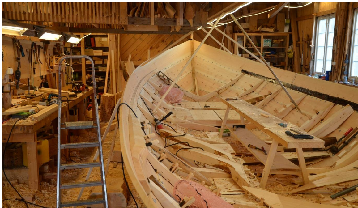
Babord esing er på plass, og styrbord skal straks gjøres fast.
