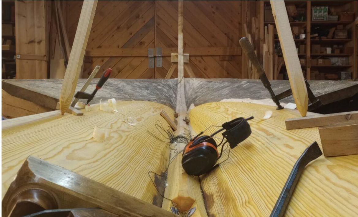
Høyden av 2. omfar blir lagt på nivå med spissen på framloddet
