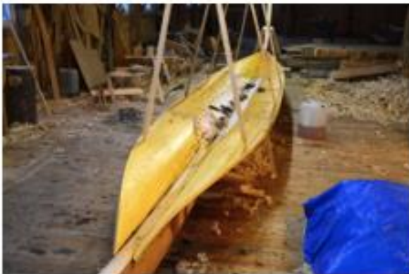
Siste finish på framhalsen . Helt alminnelig pusshøvel for skalering.
