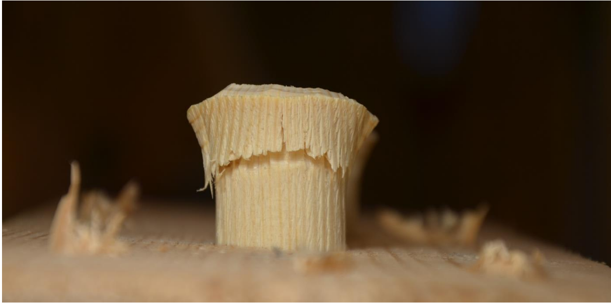
Deler av hodet er på vei av, men det sitter bedre fast enn det ser ut.
