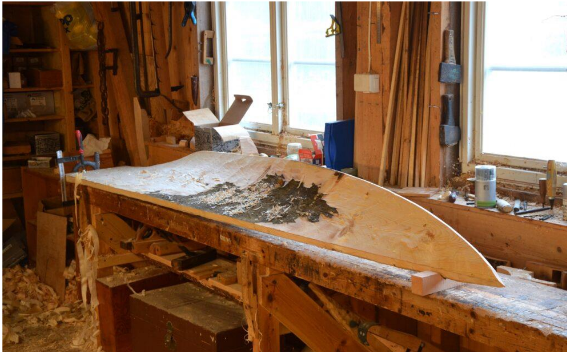
Bakhalsen er hogd til på undersida. Høvling står for tur.
