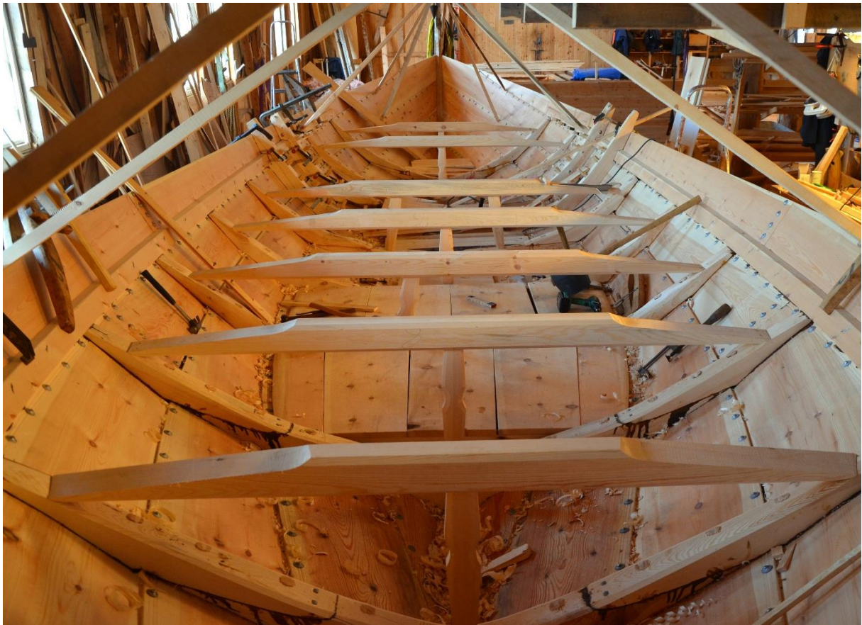
Snellene er ferdig felt og plassert. Langbanda er midlertidig festa med spiker ned i overbanda. Langbanda står en smule oppspent.
