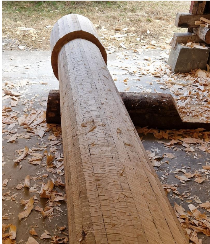
Bilde 38. Staven og basen er ferdig hogd til trettitokant. Foto Åsmund Stormoen.
