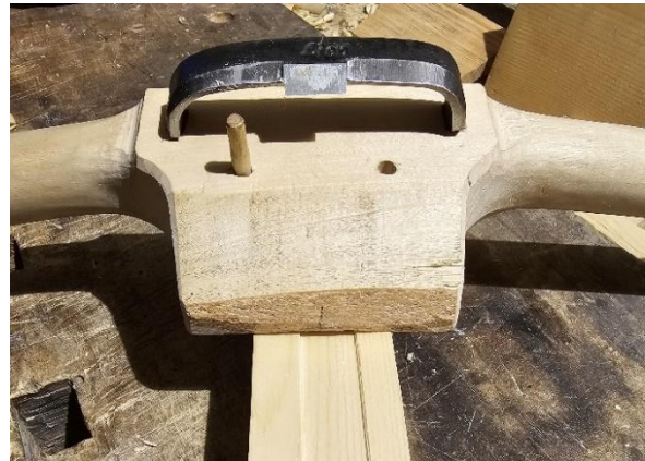
Bilde 11. Profilskavl til venstre med en 19 mm bred flat profil. Foto Åsmund Stormoen.
