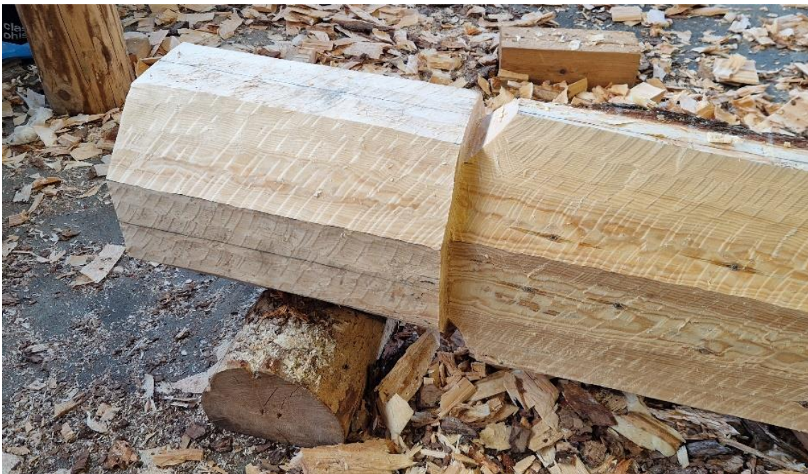
Bilde 37. Basen er hogd til åttekant. Overkanten av basen hogges ned samtidig som staven hogges. Foto Åsmund Stormoen.
