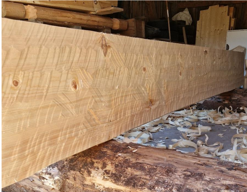
Bilde 21. Eksempel på spretteljing med langsgående reiter. Foto Åsmund Stormoen
