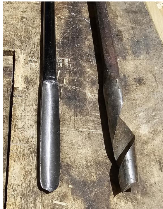
Bilde 8. Skjenavar til venstre, spiralnavar til høyre. Foto Åsmund Stormoen.
