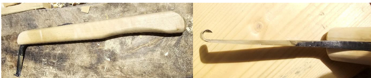
Bilde 6. Grøypjern, den runde eggen til høyre er midt mellom en u og en o i form. Dette gjør at en kan jobbe inn i sidene på tilespor. Foto Åsmund Stormoen.
