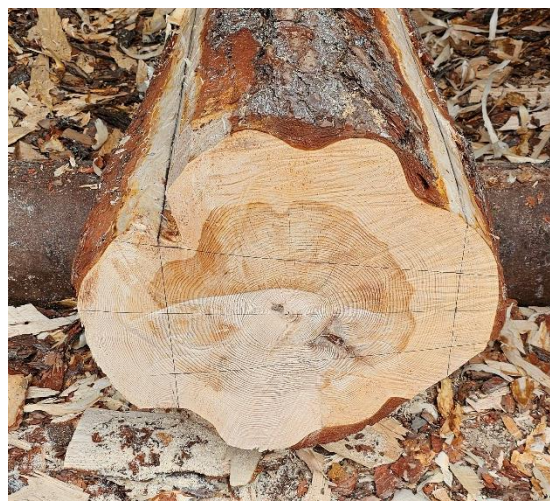
Bilde 15. Tømmerkvaliteten i arbeidsforsøket var ikke så tettvokst eller utmalma som ønsket. Foto Åsmund Stormoen.
