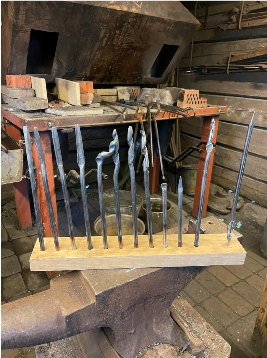
Bilde 73: steg for steg-navarsett
