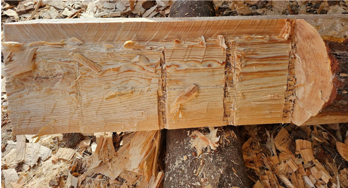
Bilde 5. Underveis i klamphoggingen teljer vi fortløpende med oss første reita langs streken. Foto Åsmund Stormoen.
