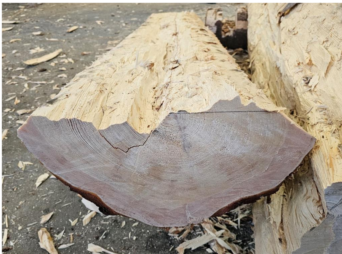
Bilde 13. Eksempel på utrivning som vil føre til mye arbeid hvis en skal hogge vekk for å få en slett flate. Foto Åsmund Stormoen.
