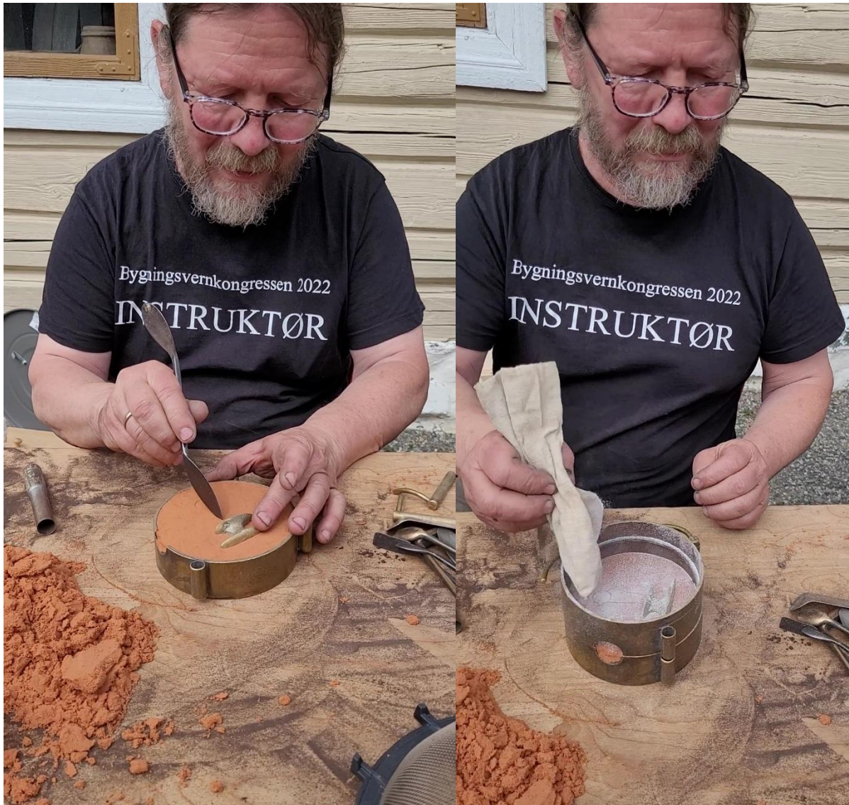
Modellen er trykt halvveis ned i formen med stampet sand og gjørtleren markerer nedløp og innløp. Foto: Hanne Bergseth
