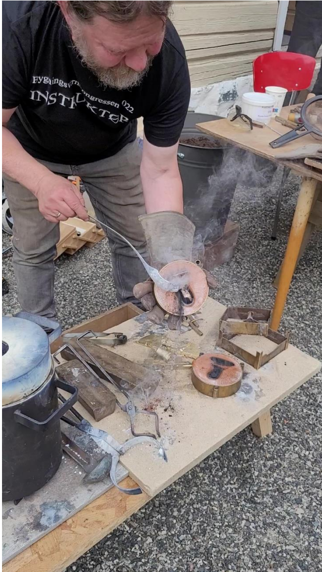
Totto har skilt formkassedelene og pirker ut den støpte gjenstanden. Foto: Hanne Bergseth
