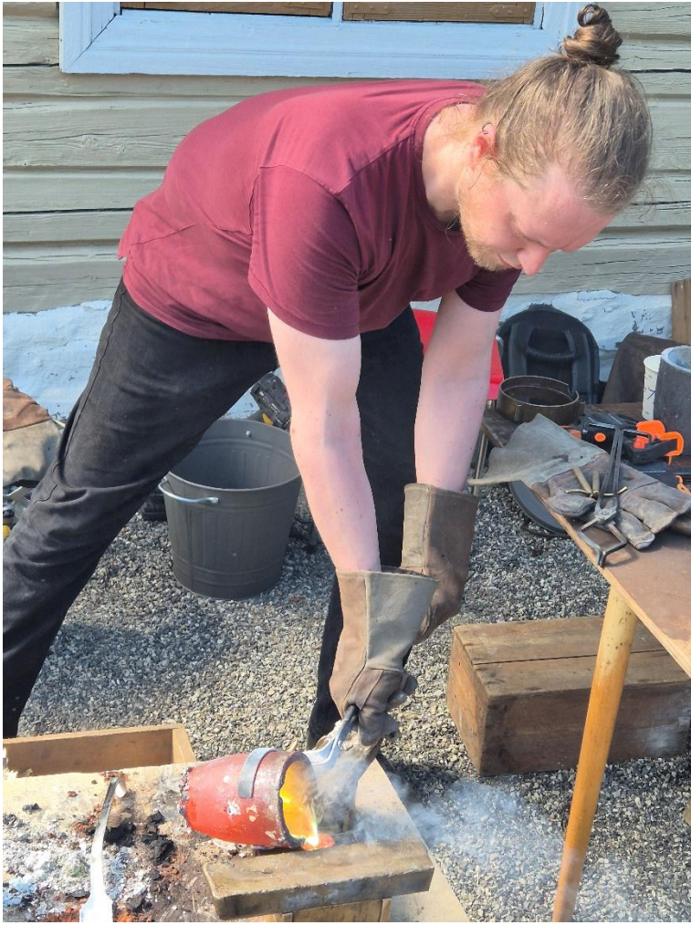
Anders fyller støpeformen sin med flytende messing. Her støper han deler til en liten kniv. Foto: Inger Smedsrud
