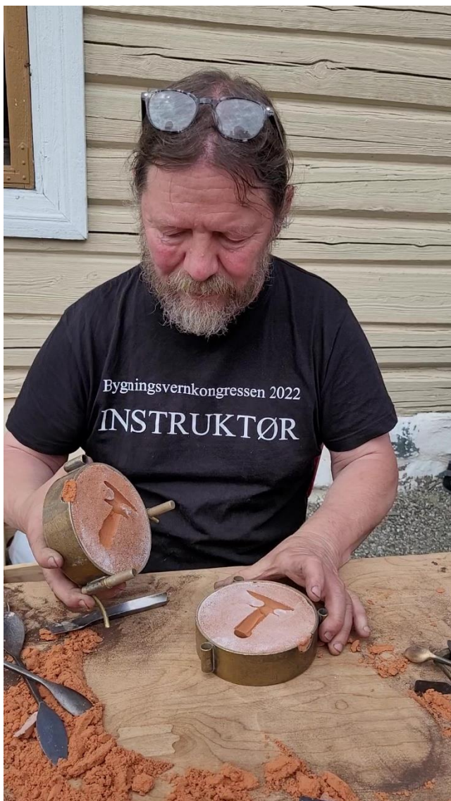
Arbeidet med sandformingen er snart fullført. Her har Tutto laget nedløp og innløp til det negative avtrykket etter modellen og monterer de to delene av formkassen sammen. Foto: Hanne Bergseth
