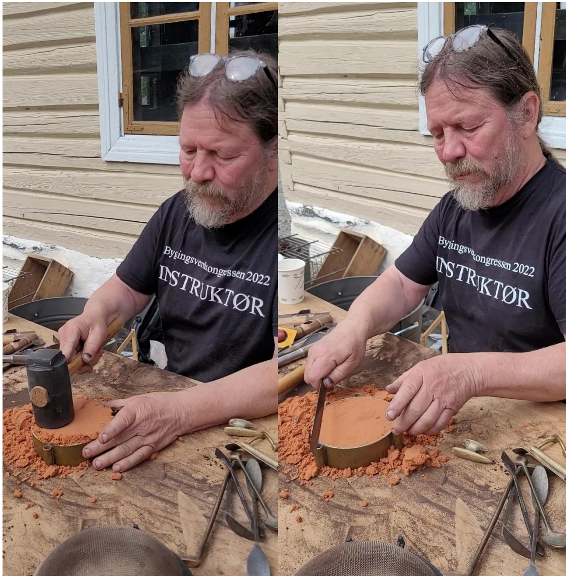
Totto stamper sanden fast i formen og bruker en «kniv» for å rette av overflaten. Foto: Hanne Bergseth
