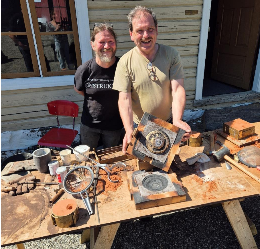
Terje Skaugvold viser et vellykket støp i formkasse av tre. Foto: Inger Smedsrud
