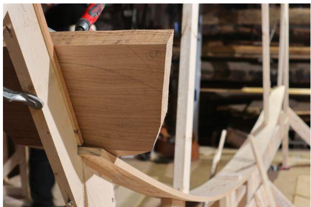
Forspeilets plassering i forhold til kjølbordet.
