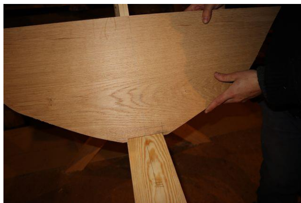
I akterspeilet lages et fellespor som tres ned over kjølbordet. Først sages, deretter brukes hoggjern. At fellesporet blir tett er viktig for at prammen ikke skal lekke.
