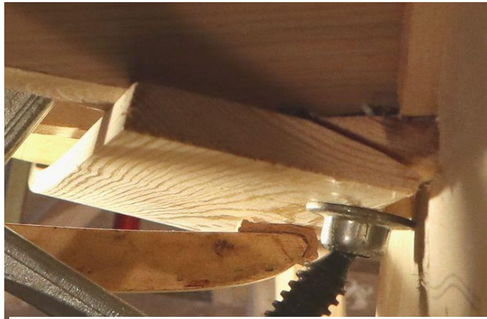
Bunnbordet og kjølbordet forkanter. Framspeilet over.
