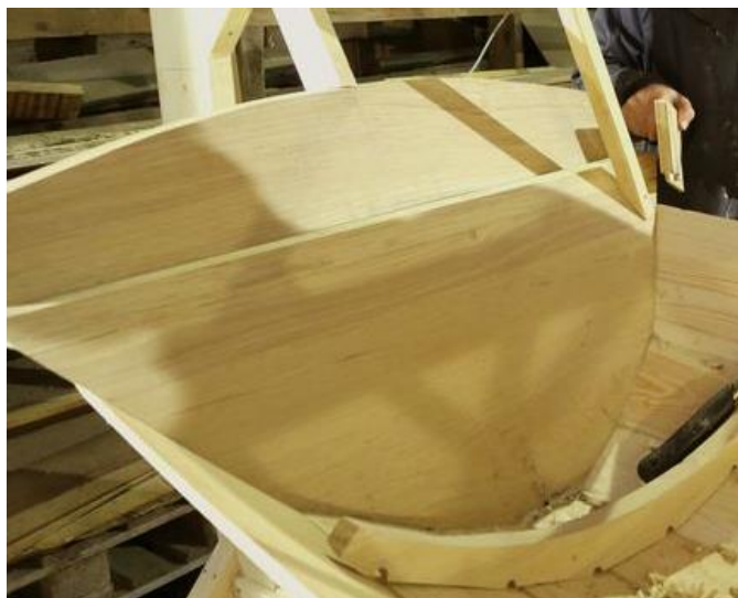
Akterspeilets øvre del, hekkfjøla, er kommet på. Den er av eik, som de andre speil-delene. Nå skal øverste bordgang settes inn.
