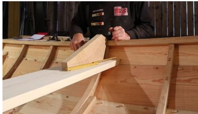
Over: Tofteknede av eik tilpasses mellom esingen og toftene.
