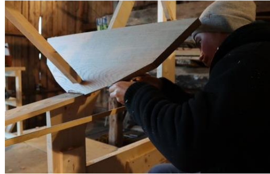
Kantene på akterspeilet «files ned» med mange ulike egg-redskaper. Reia henger der og løftes opp som en mal og viser hvor bunnbordet kommer.
