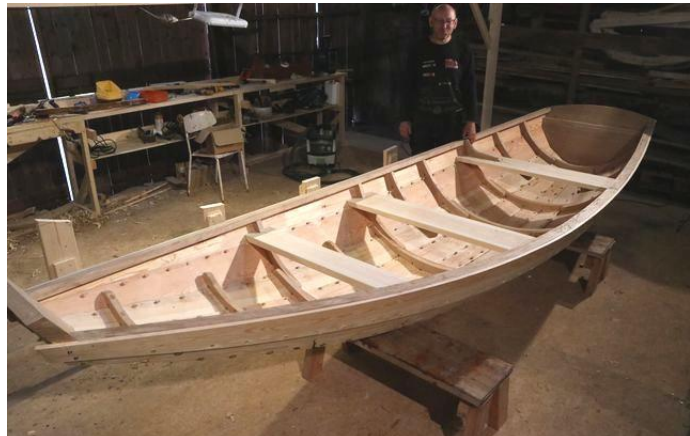
Prammen er tatt ned fra beddingen. På oversiden er det tolepinner og ferdiggjøring av framspeilet som gjenstår.
