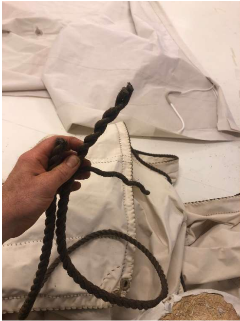
Figur 24 Åpne tauet og ta ut en kordel
