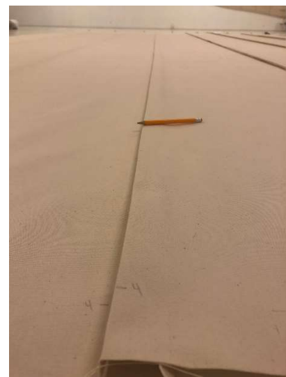
Figur 16 Bildet til venstre viser oppmåling med snorer, bildet til høyre viser innbrett og overrettmerker
