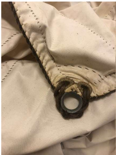
Figur 27 Ferdig slått løyert med stålkause
