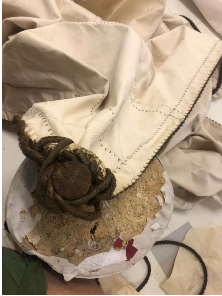
Figur 26 Utvide øyet med ters og slå inn kausen
