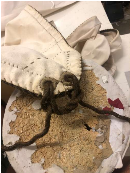
Figur 25 Spleise øyet tilpasset kausen
