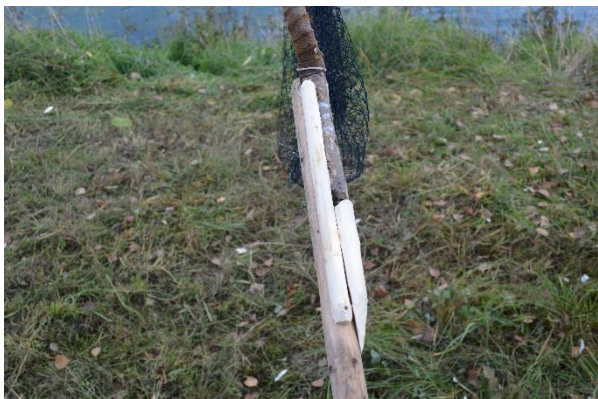
T.v.; Håvhugguet er reparert med nytt trevirke. Råttent trevirke er spikket bort slik at tyngden av håvhugguet blir omtrent som før.
