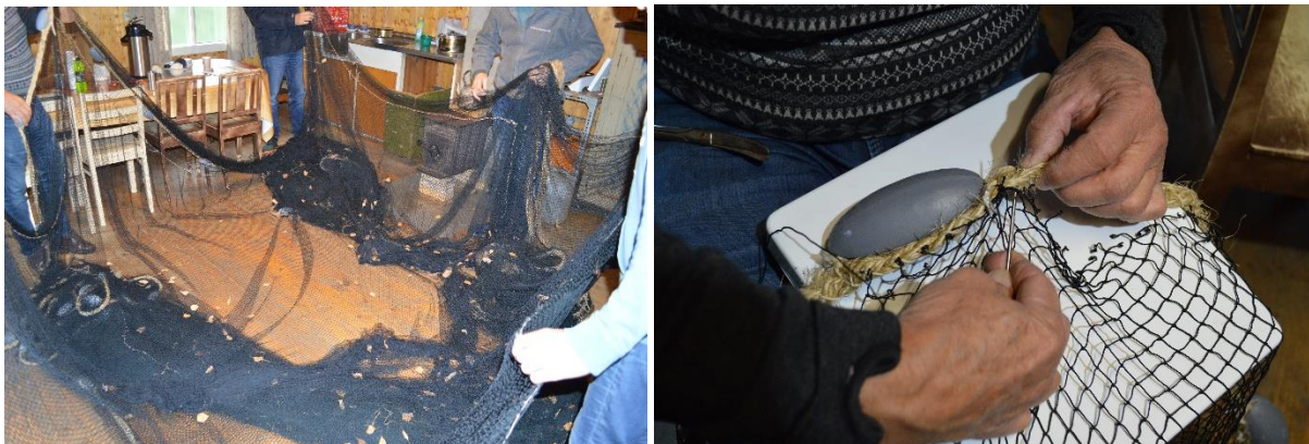
Fra oppholdsrommet i bua hvor nota ettersees og evt. repareres. Her fra reparasjon langs flætennolen.
