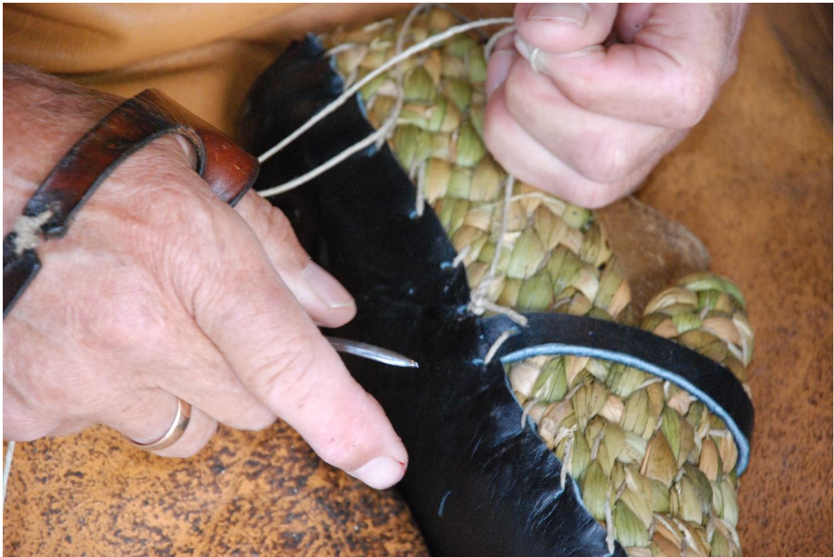
Siste sting festes godt i knuten med løkke skomakeren laget når han startet å feste skinnsålen.
