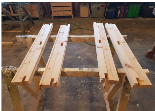
Tapp, sliss, postprofil og karmfals produsert på bordfres
