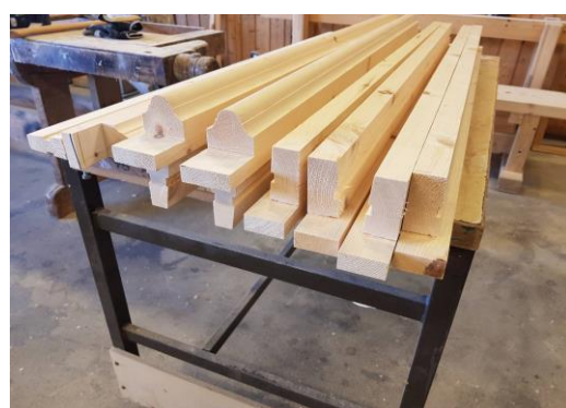
Tapp, sliss, postprofil og karmfals produsert på bordfres
