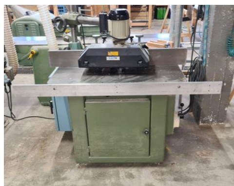
Bordfres med mateaggregat
