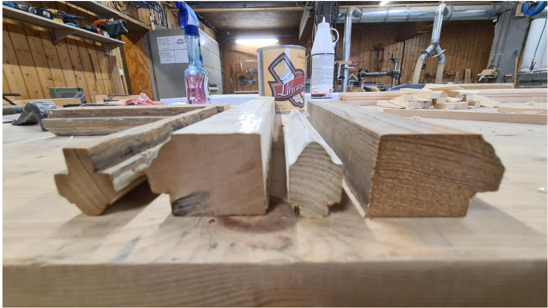
Ramtre og sprossematerial, samme vindu, beviste plasseringsvalg?
