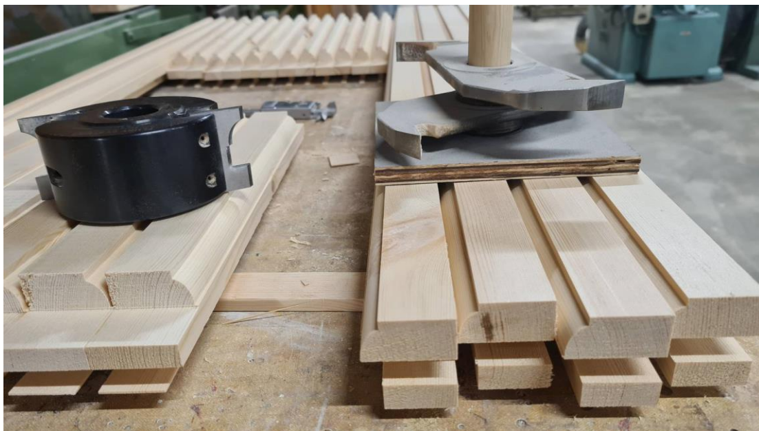
Hjørne og srossesammenføyning, nakking, gjæring og kontraprofil
