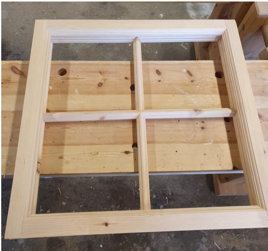
Ferdig og klart for maling og glass
