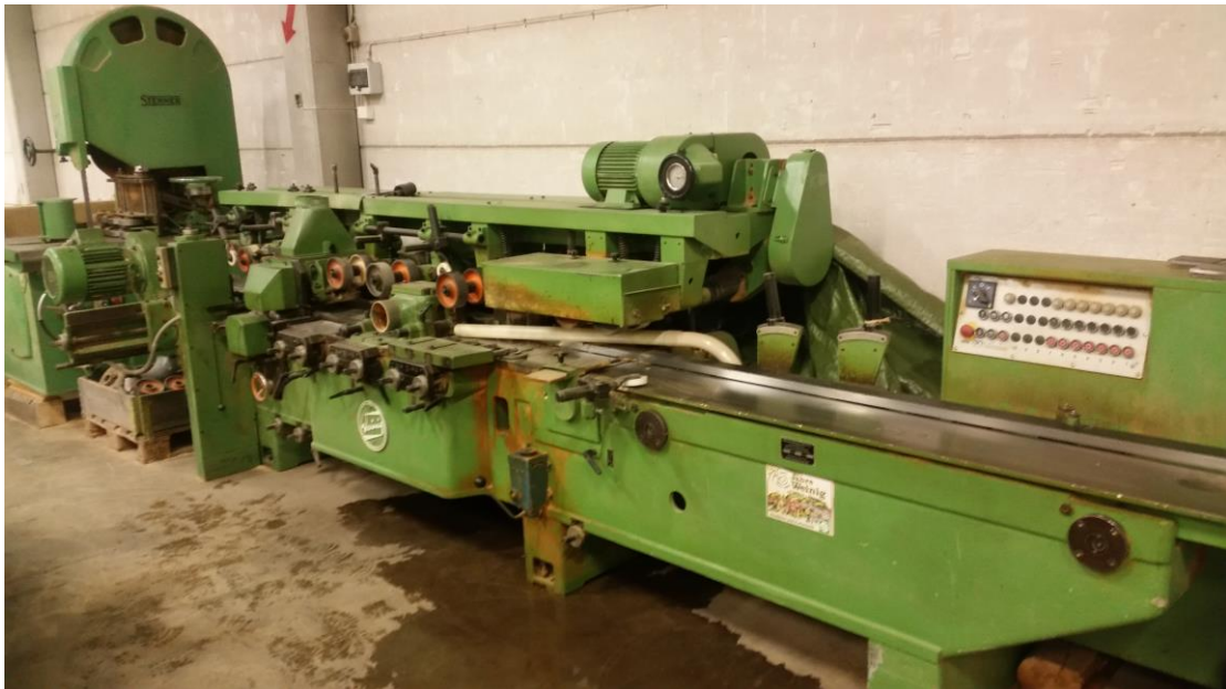
7 spindlet moulding, ca. 1980 Oppdal.
