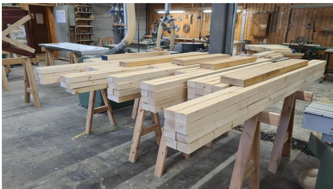
Dørkarmemner før sammenliming og dimensjonering.
