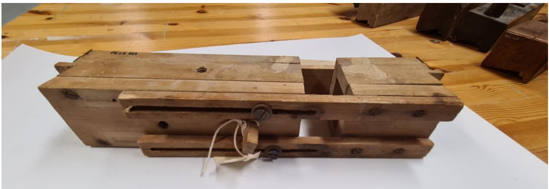
Sagjigg til kontraprofil, skråkant.
