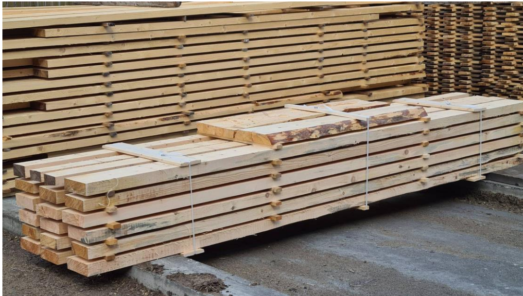
Furu før maskintørking ved Trones bruk/ Inntre AS.
