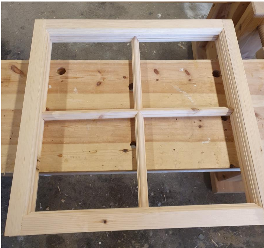
Ferdig og klart for maling og glass.
