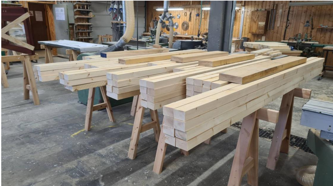
Dørkarmemner før sammenliming og dimensjonering.
