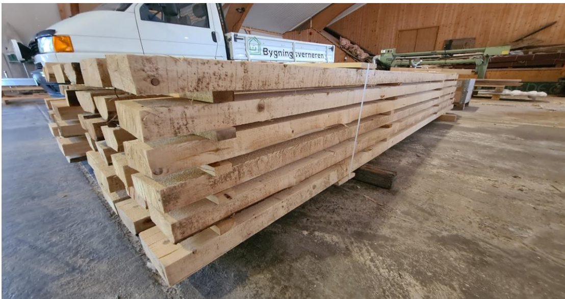
Gran og furu etter maskintørking ved Trones bruk/ Inntre AS.
