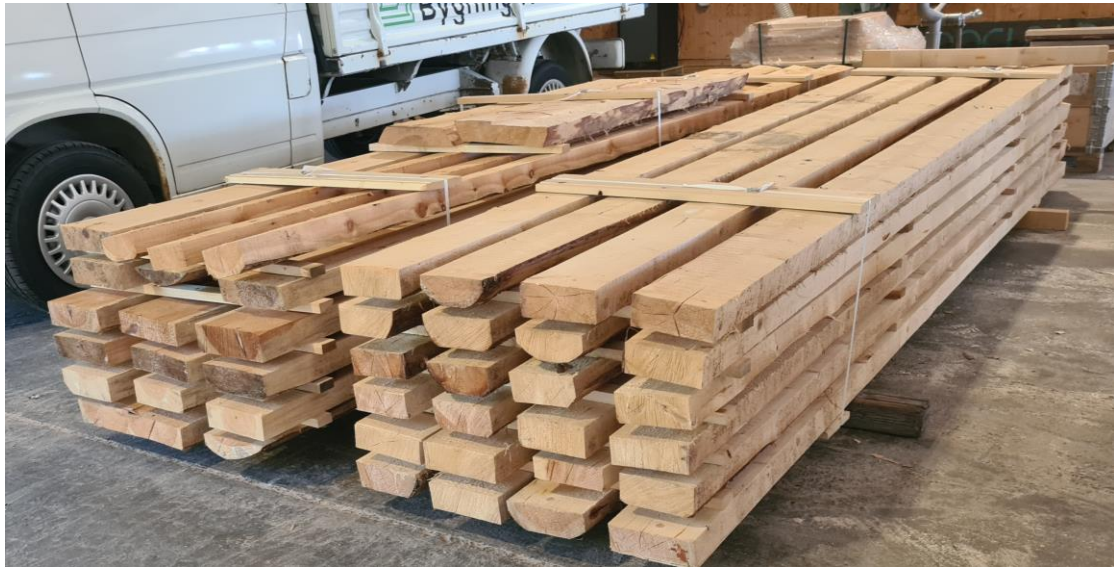
Gran og furu etter maskintørking ved Trones bruk/ Inntre AS.
