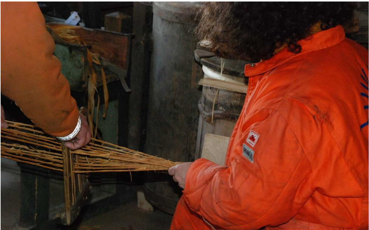
Renningstrådene justeres slik at de blir like lange. For å holde renningen stram brukes et snøre rundt livet som er festet gjennom renningen.
