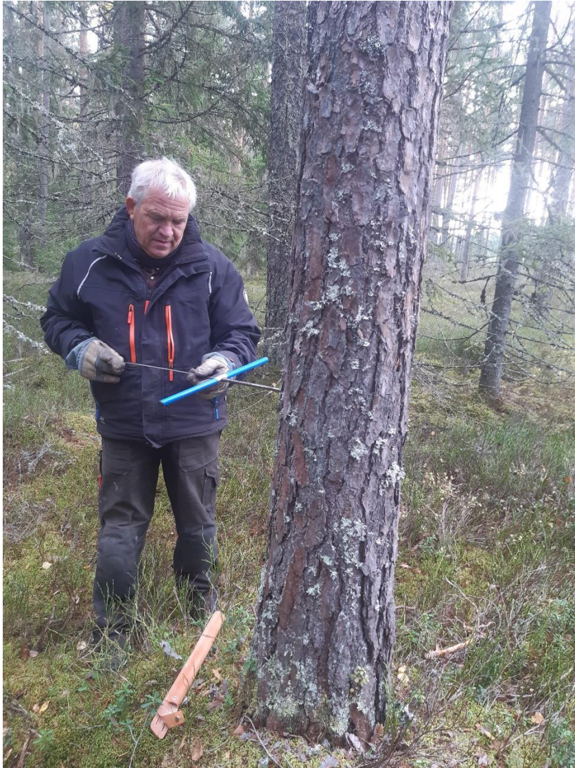
Min veileder Hans Marumsrud i gang med å gjøre en boreprøve av et tre som kunne ha omtrent samme egenskaper.
