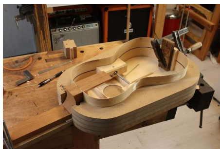
Den spanske byggemåten der hals og lokk ligger opp ned på en grunnplate (i dette tilfelle også med en utvendig form)
