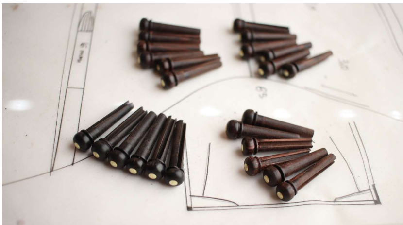
Selvlagde strengeplugger i palisander og ibenholt med detaljer i messing
