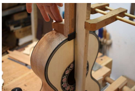
Halsvinkelen justeres ved hjelp av en mal som viser strengelasseringen ved stolen
