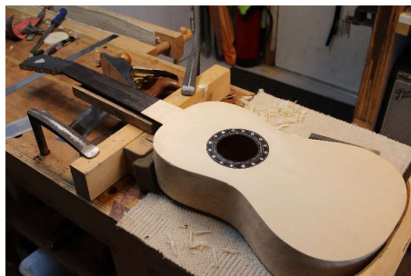
Lokket limes på sist og låser geometrien mellom halsen og kroppen
