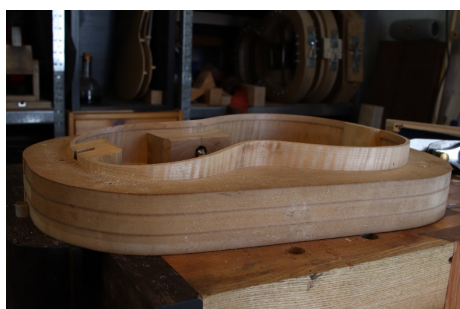
Detalj: Sarghøyden ble justert ut fra buene i bunnen
