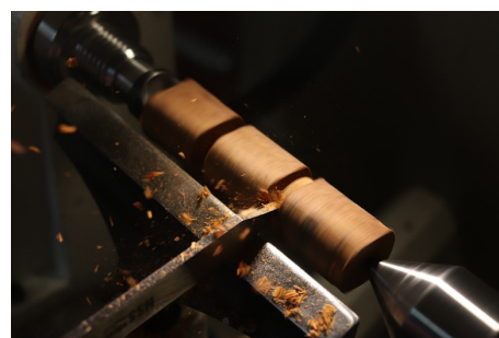
Detalj: For å dreie stemmeskruene var jeg mer opptatt av repetisjonene enn av detaljene i utførelsen
