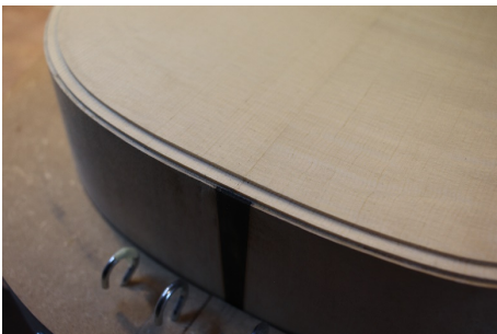
Detalj: Forarbeid med kantlistene
