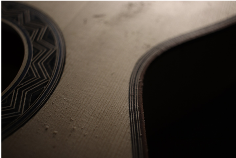
Detalj: Pussing av lokket med sikling
