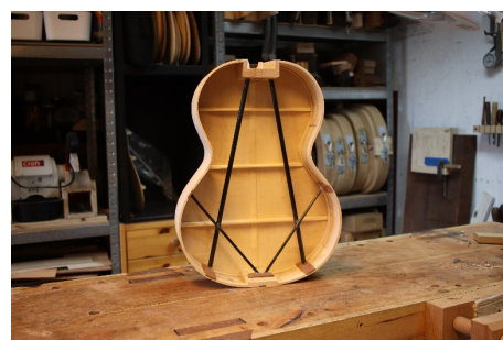
Forsterkningsstrukturen av karbonfiberstenger
