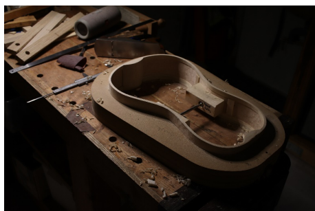
Detalj: Justering av sargkantene
