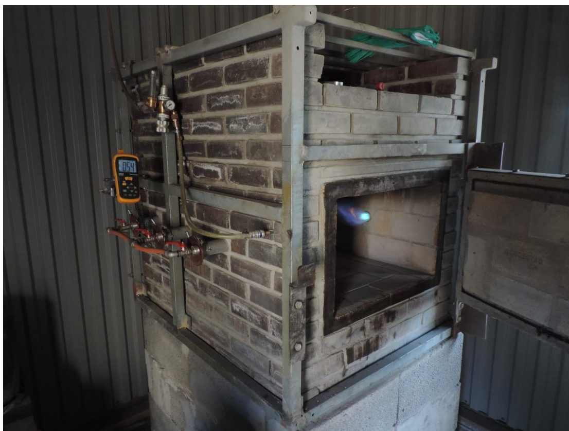
Påske 2018. Omnen er ferdig. Seks injektorbrennarar på plass i sine respektive brennrøyr, digitalt termometer og argonregulator for evt. bakgass på plass. Døra i eldfast stein er fiksert i eit bur av firkantrøyr i galvanisert stål
