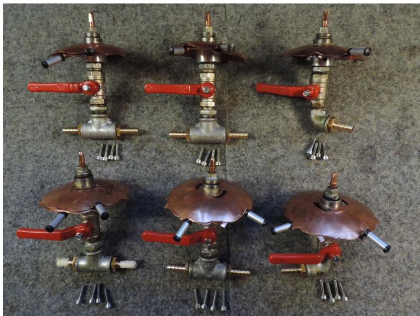
Brennarane, som er av injektortypen, dreg med seg oksygen frå lufta utanfor ved hjelp av trykket i brenngassen (propan). Gassblandinga gjer det mogeleg å nå temperaturar over 900 grader Celsius.
