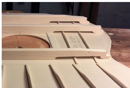
Detalj. Oppbygging av lokket i en moderne klassisk gitar
