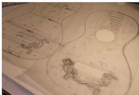
Museumstegningene (foran) gjort om til arbeidstegninger (bak)
