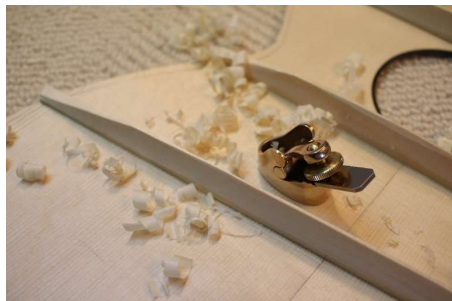
Detalj. Finjustering av bjelkene
