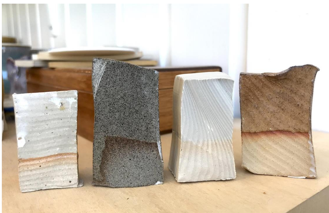
Fire transparente blanke glasures forbindelse og virkning på fire forskellige stentøjsler
