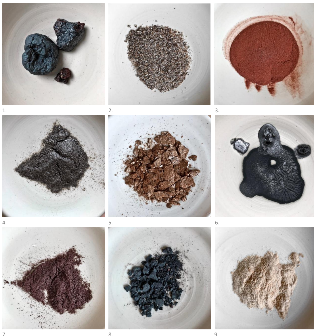
Smelteprøver (1260 grader). Et udvalg af Rørsråmaterialer fra: 1. Storwartz, 2. Kvitsanden, 3. Mølmannsdalen, 4. Lergruvbakken, 5. Storwartz, 6. Storwartz, 7. Lergruvbakken 8. Storwartz, 9. Mølmannsdalen.
