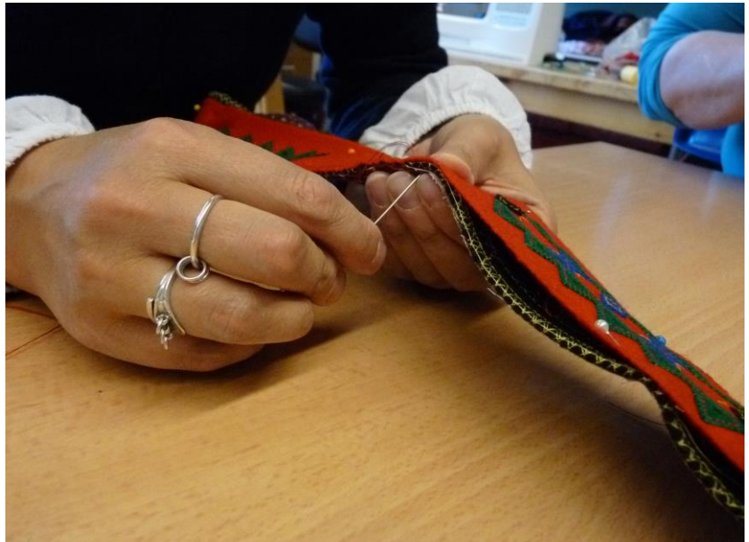
Innlegg, fôr og dekorert belte blir sydd sammen for hånd med kastesting. Det er mye holdning på fôr og innlegg, som må fordeles under sammensyningen.
