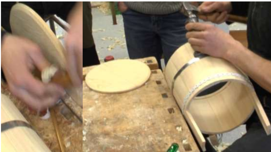
Kai har høvlet bunnen plan og høvlet fas på kanten på undersiden med en skavkniv, før han løsner på hjelpebåndet for å få felt inn bunnen i bøtta.
