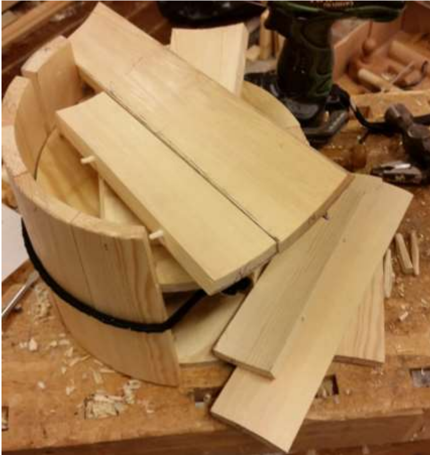
Mal med ferdige staver delvis satt sammen. Ørestaven ble formet først.
