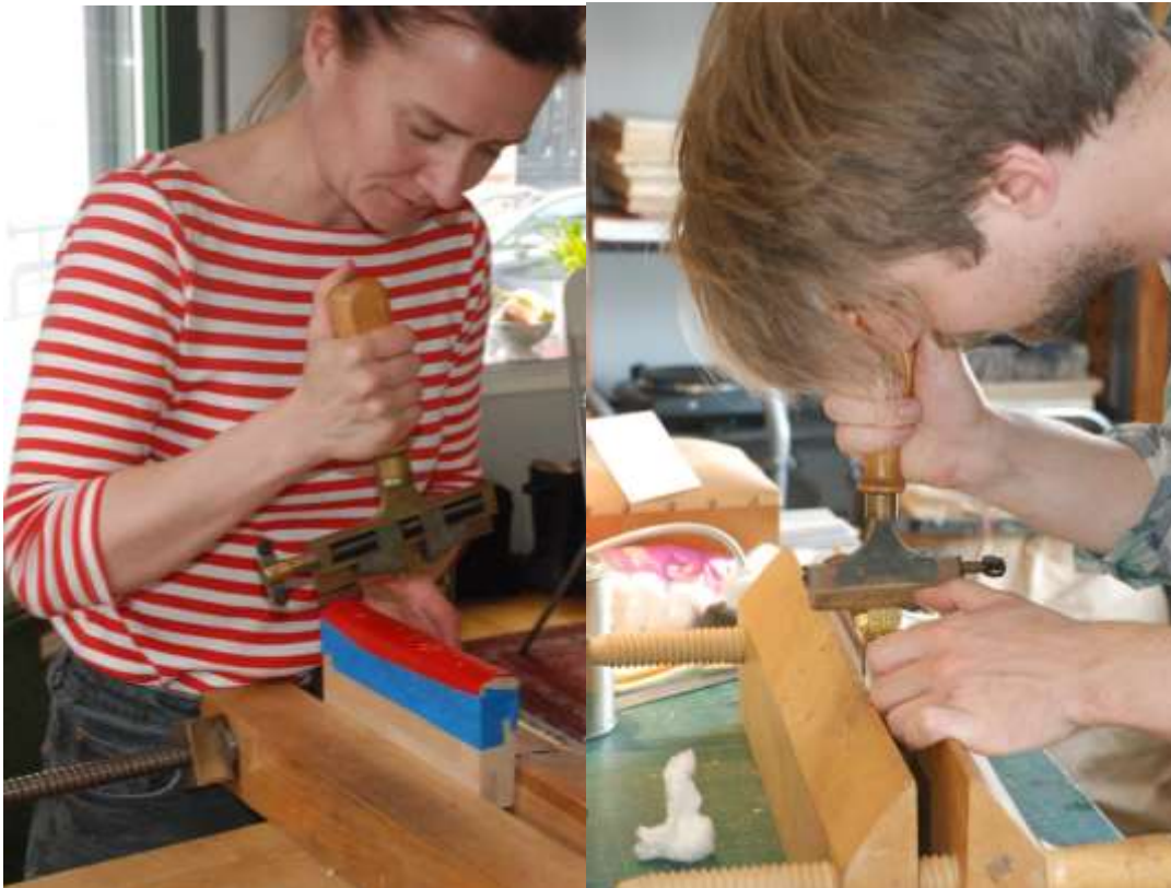
Vibeke og Georg trykker titler på bokrygger med metallbokstaver satt inn i skriftkasser.
