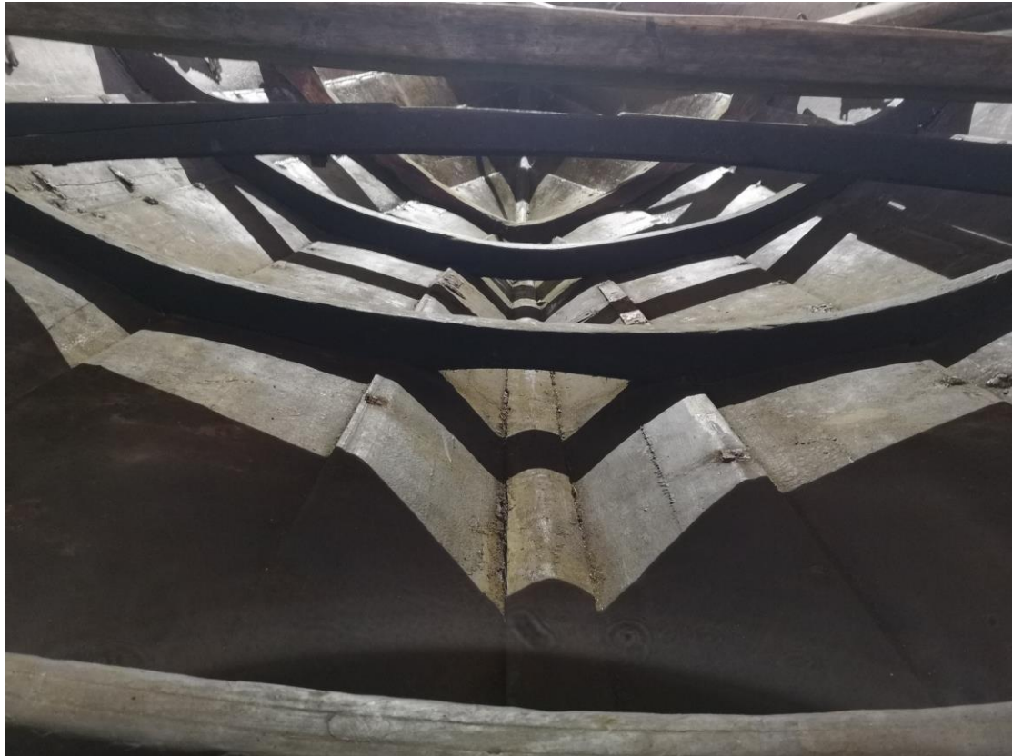
Bordløp framover i ein ladromsbåt bygd for brugdefangst for kring 200 år sidan.
