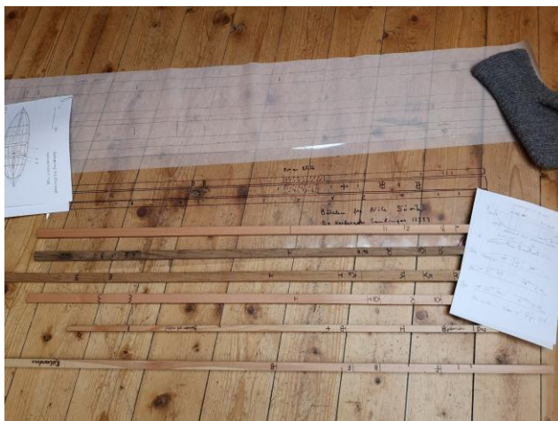
Døme på alnstavar til oselvarar. Dette er utgangspunktet for bygging av dei ymse storleikane av oselvarar.
