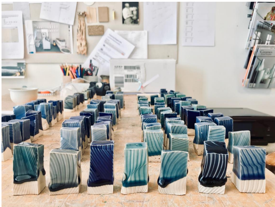
Indfarvede glasurprøver brændt til 1260 grader med 10 min. holdetid
