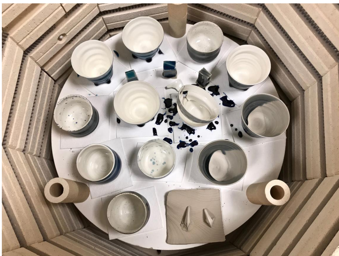
Glasur der har kogt på vej op til toptemperatur
