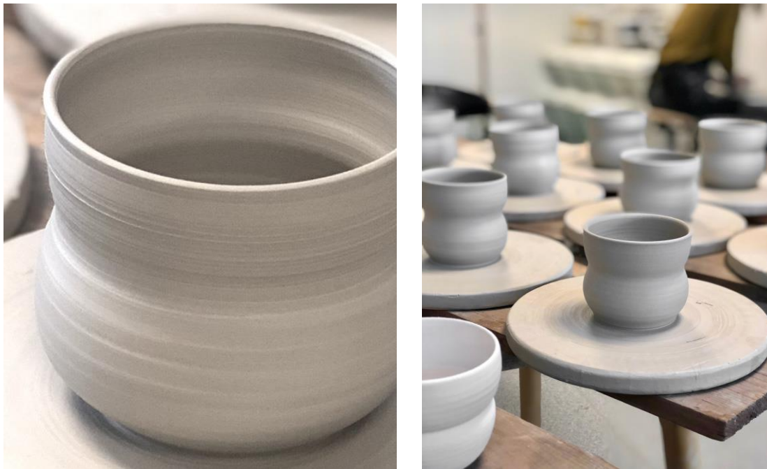
Test af ler på drejskiven, med drejning af prøveopper. Overfladeprøver med bl.a. tydelige og udviskede drejeriller.
