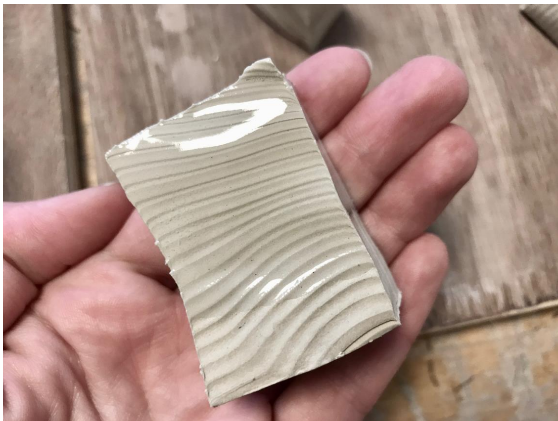
Kasjas glasur. Transparent blank glasur brændt til 1260 grader.
