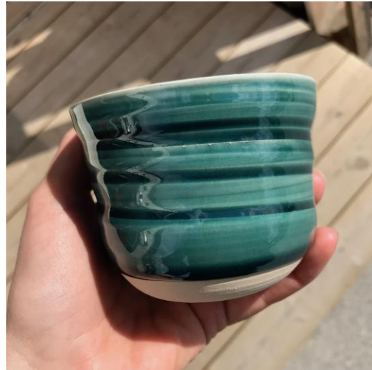
2 (th.) Dyppeglaseret med samme glasur, medium tykt lag, 1255 grader, 5 min holdetid.
