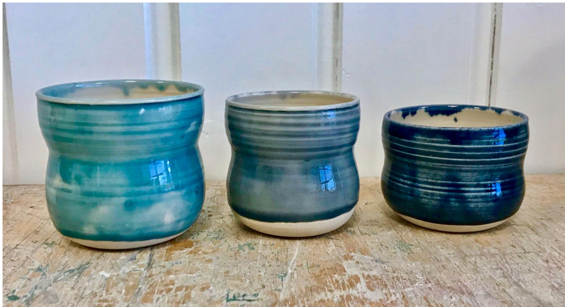
1. kop tv. er hælde glaseret indvendig, penslet udvendig. 2. kop (i midten) er hældeglaseret indvendig, dyppeglaseret udvendig. 3. kop th. er hældeglaseret indvendig, hældt over udvendig.
