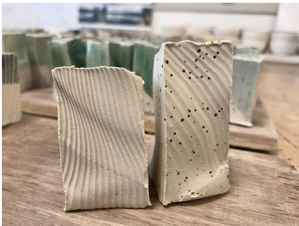
Det udvalgte stentøjsler WMS2502 og WM2502, højtbrændt til 1260 grader
