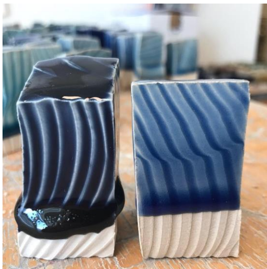
Eksempler på blokprøver fra det blå glasurbibliotek
