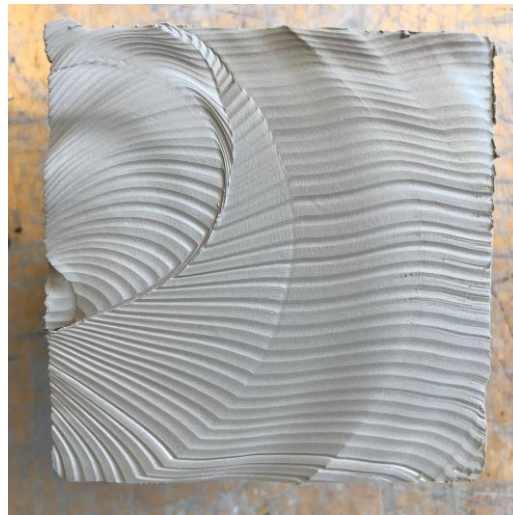
10 kilos blok med stentøjsler skåret med snoet skæretråd, der efterlader relief effekt.
