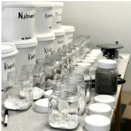
Afvejning af 100g glasurprøver, med indfarvning af oxider
