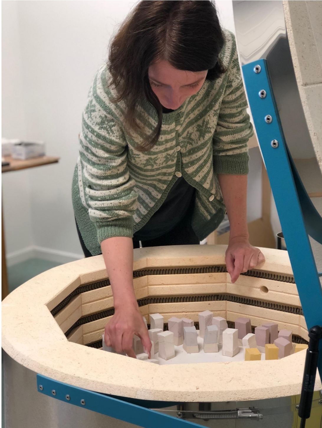
Ovnen pakkes med første glasur blokprøver
