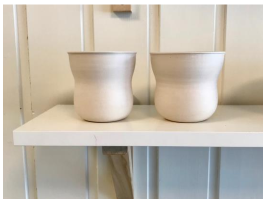
Kopper klar til forglødning (1. brænding, 980 grader)
