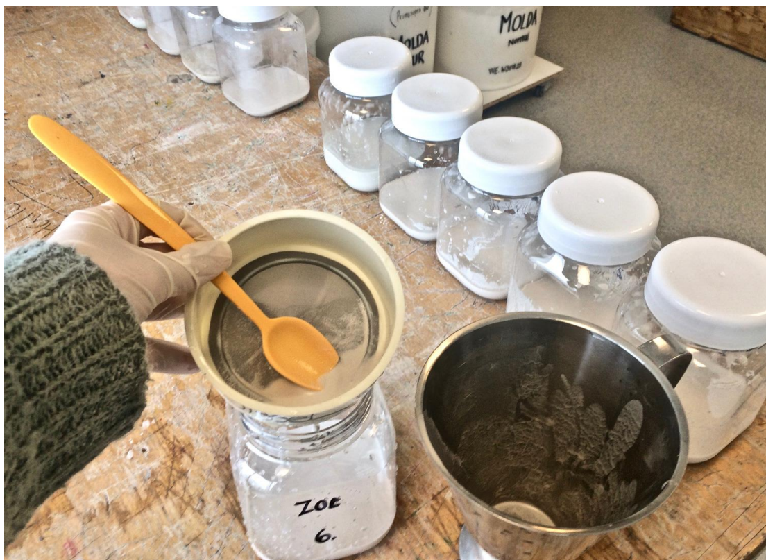
Blandingsproces med sigtning af glasurprøver.
