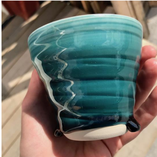
1 (tv.) Dyppeglaseret med ekstrem tyk glasur, 1260 grader, 5 min holdetid.
