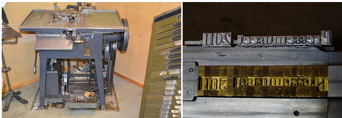
Ludlow tittelsettemaskin t.v. Matriser i vinkelhaken og ferdig støpt linje t.h.
