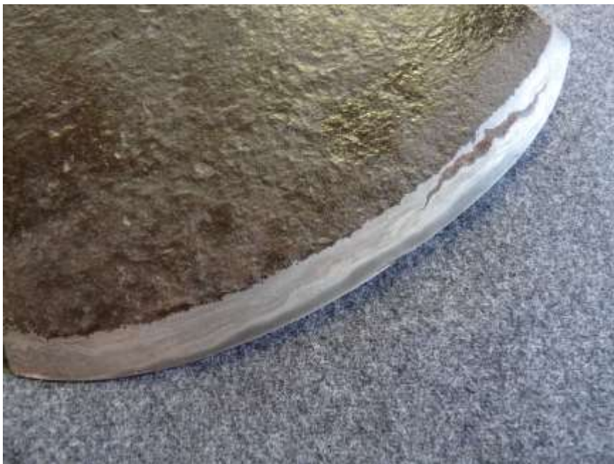
Figur 30 Etset økseegg på Agder-bile.
