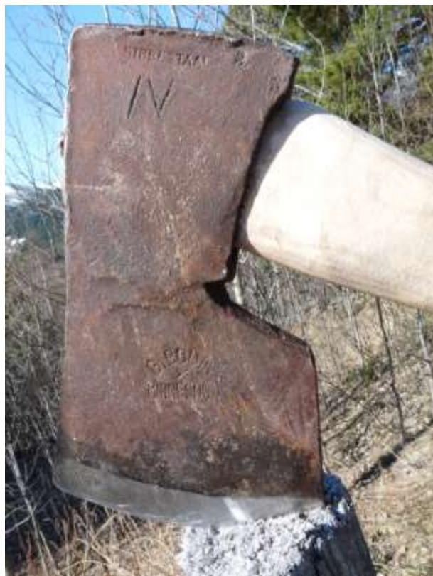
Figur 27 Mustadøks stålet om av Bodin.
