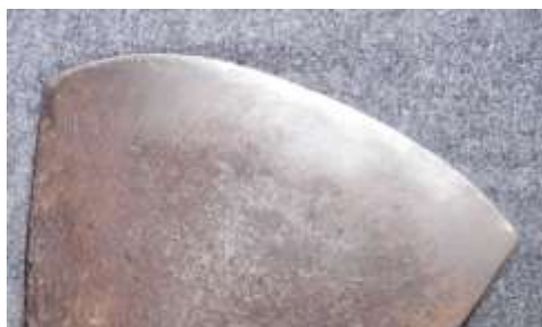
Figur 57 Perfekt stålsetting av saksebile
