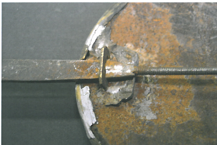
Tinnlodding på pendellinsens bakside.
