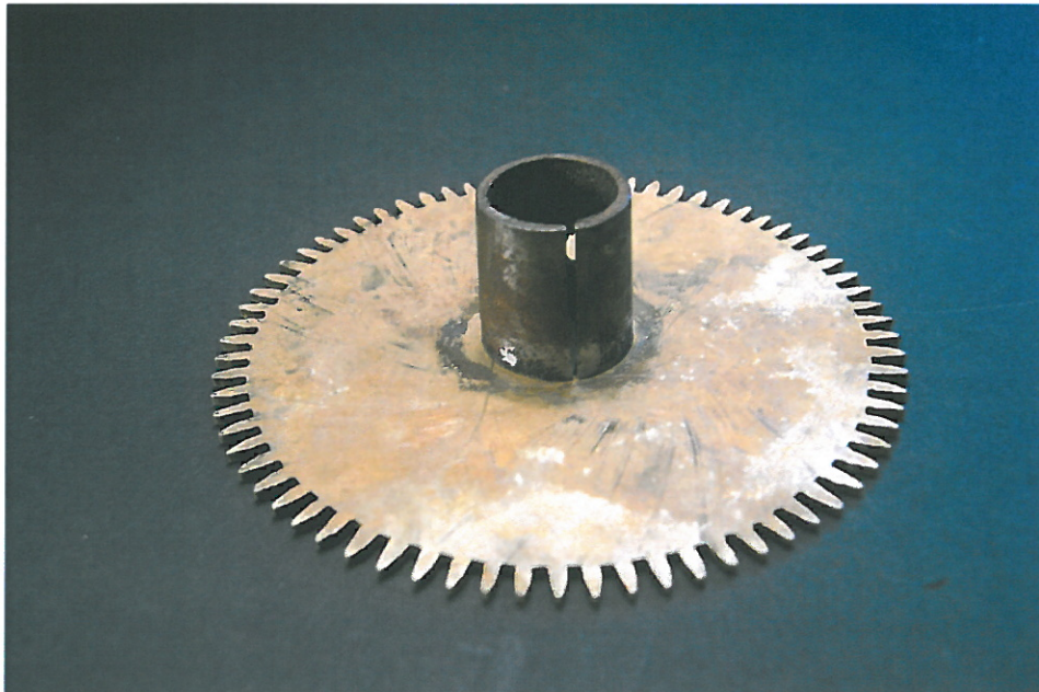
Timehjul med sentrum av jern. Sprekken langs røret ses godt.
