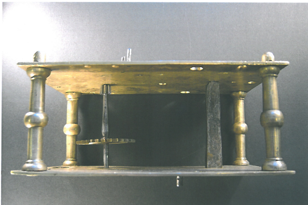
Verkplater og verkpilarer. Legg merke til at ganghjulet på bildet står skjevt mellom verkplatene.
