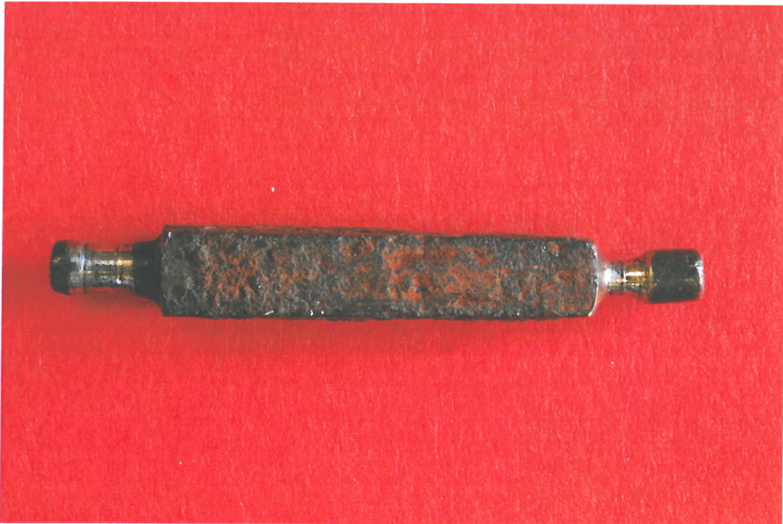
Akse som er slått ut av trinse.
