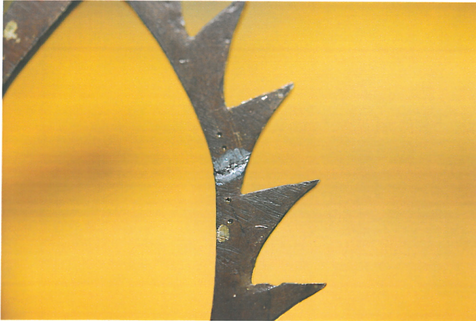
Skade på ganghjulets tannring.
