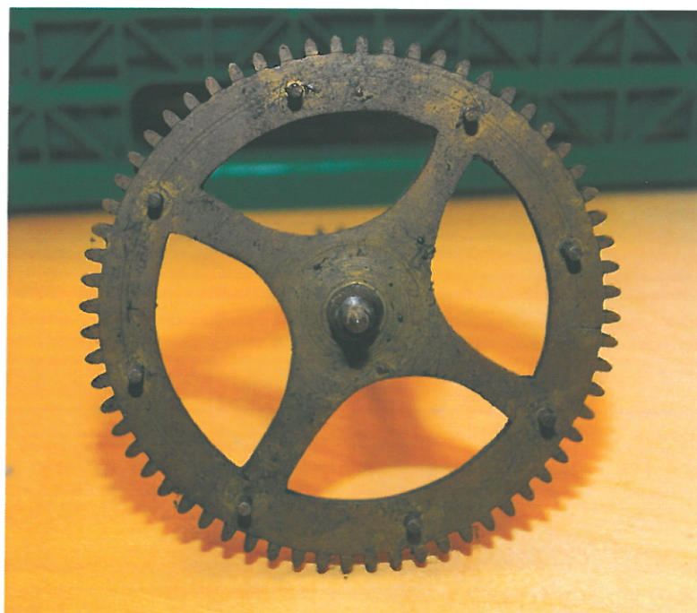
Hammerløftehjul slagside, laget av messing.
