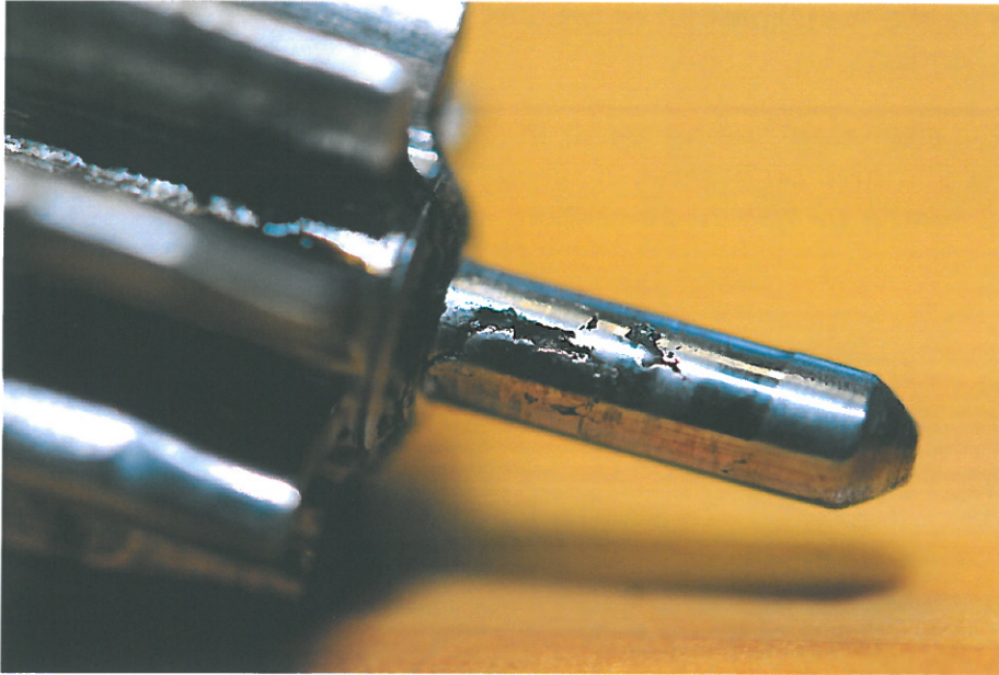
Skadet tapp på drevsiden til lille mellomhjul
