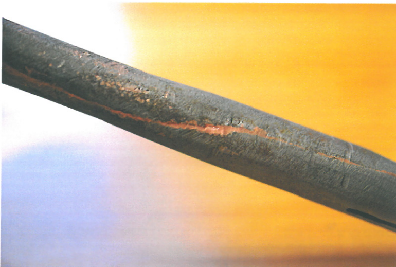
Kobberfaget materiale langs aksen fra slaginndeingshjulet.
