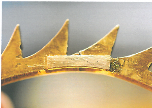
Ferdig lask montert på ganghjulets tannring.
