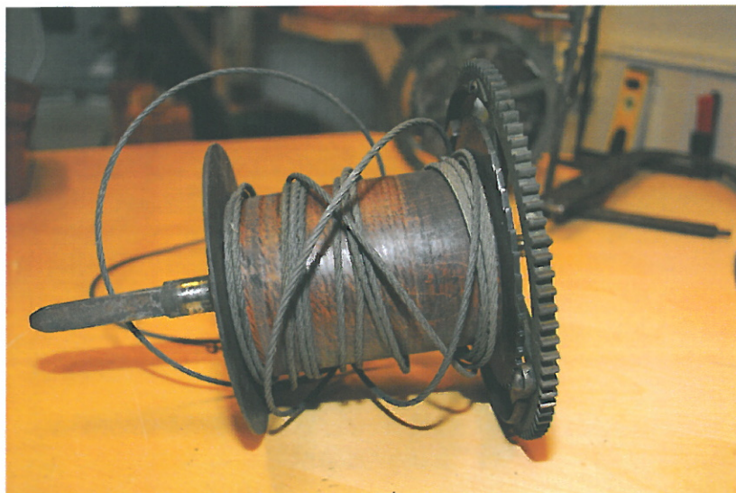
Valse tilhørende slagsiden med koniske ender på aksene.
