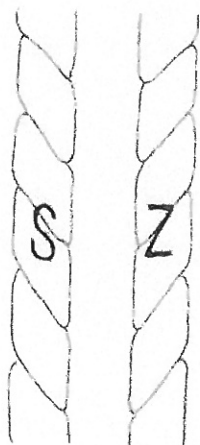
Spinneretningen betegnes med de internasjonale betegnelsene S og Z. (figur fra Lise Warburg's Spindebog)
